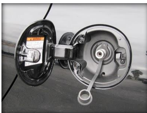
Εικ. 4.6: τάπα ρεζερβουάρ φυσικού αερίου
