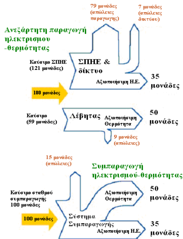
Σχήμα 4.1 Σύγκριση βαθμού απόδοσης συμβατικού σταθμού παραγωγής ενέργειας με σύστημα ΣΗΘ
