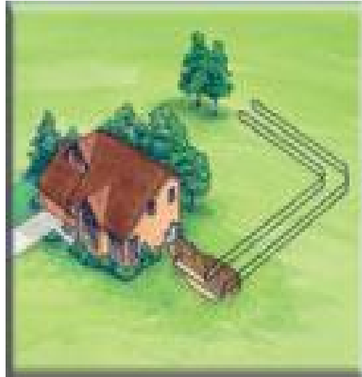
Σχήμα 2.6.3: Συστήματα οριζόντιου γεωθεναλλάκτη.[10]
