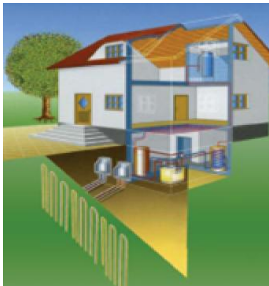
Σχήμα 2.7.4: Σύστημα ενεργειακού φράχτη.[10]
