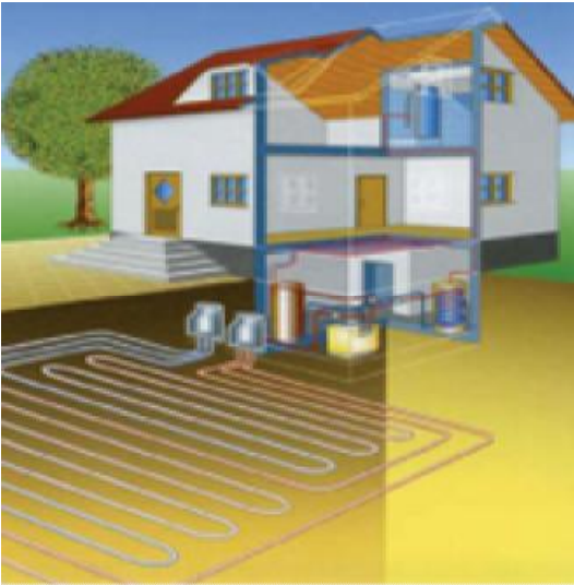
Σχήμα 2.6.3: Συστήματα οριζόντιου γεωθεναλλάκτη.[10]
