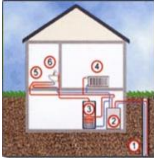
Σχήμα 2.5.1: Εγκατάσταση κατακόρυφου γεωεναλλάκτη.[7]
