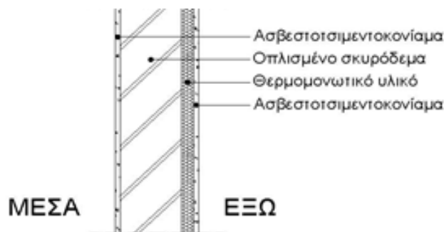
Σχήμα 2.1: Δομικά υλικά εξωτερικών δοκών-υποστυλωμάτων
