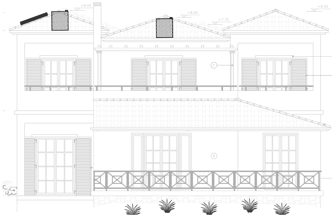
Σχήμα 2.10 : Θέση panel ηλιακού σε όψη, στην στέγη του κτιρίου
