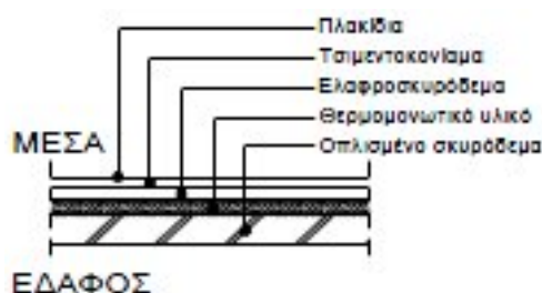
Σχήμα 2.5: Δομικά υλικά θερμομονωμένης οροφής στον εξωτερικό αέρα
