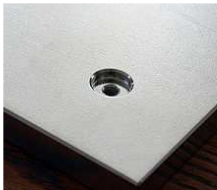
Σχήμα 11 Παράδειγμα Counterbore οπής.
