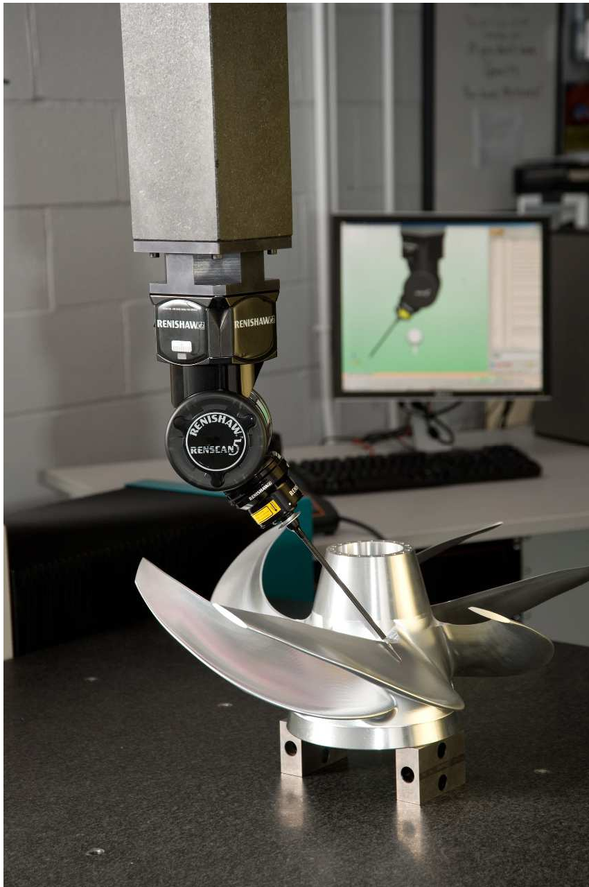
Σχήμα 26 Επαφάς – αισθητήρας (touch probe) για την μέτρηση σημειακών μετρήσεων.
