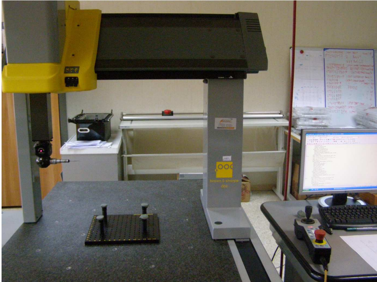
Σχήμα 30 Η CMM που χρησιμοποιήθηκε για την διαστασιολόγηση του κομματιού
