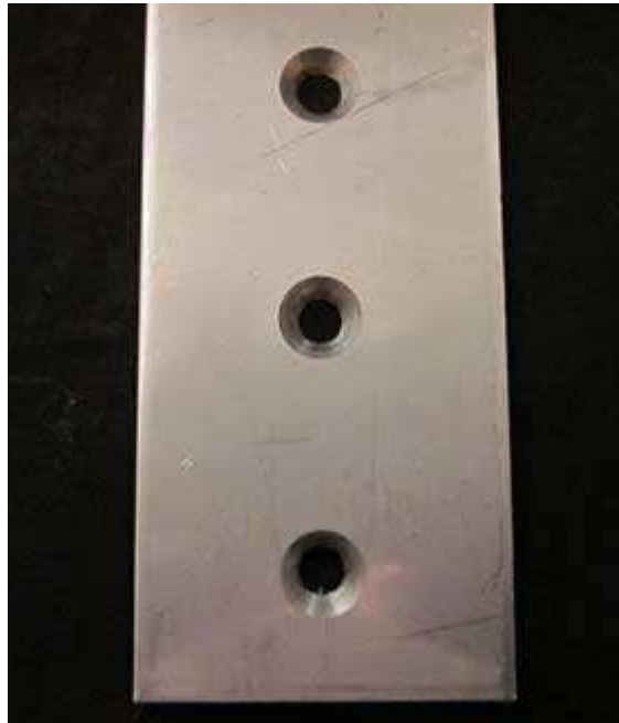
Σχήμα 12 Παράδειγμα Countersink οπής.
