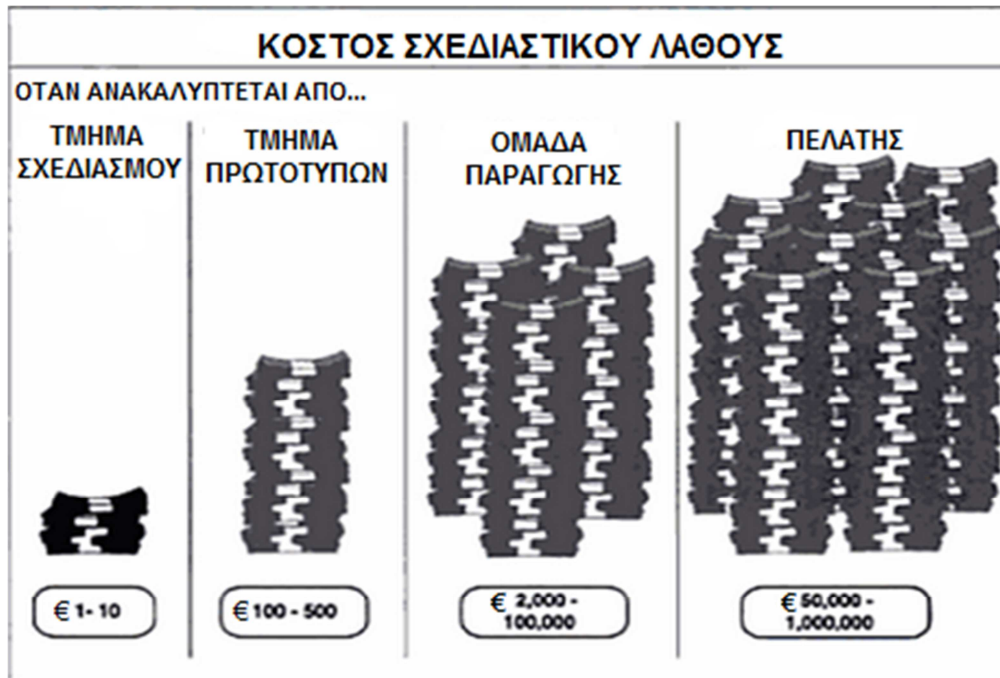
Σχήμα 2 Η αύξηση του κόστους ενός σχεδιαστικού λάθους καθώς αυτό "προχωράει" μέσα στην επιχείρηση
