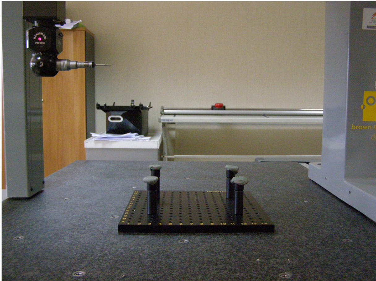
Σχήμα 31 Βάσεις έδρασης για την τοποθέτηση του τεμαχίου
