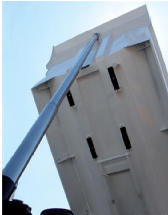
Εικόνα 40: Τηλεσκοπικοί κύλινδροι μονής ενεργείας μεγάλης διαδρομής σειράς Ε.
