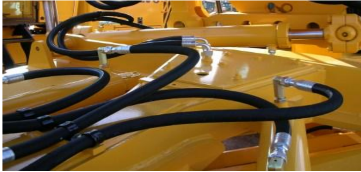
Εικόνα 47: Εξαρτήματα και εύκαμπτοι σωλήνες πρέπει να εγκατασταθούν σωστά για ελαχιστοποίηση της φθοράς.
