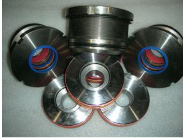
Εικόνα 46: Περικόχλια συγκράτησης εμβόλου με εμφανή τις στεγανοποιητικές ροδέλες
