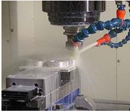
Εικόνα Νο. 2 - Κατεργασία κοπής μηχανολογικού εξαρτήματος σε φρέζα
