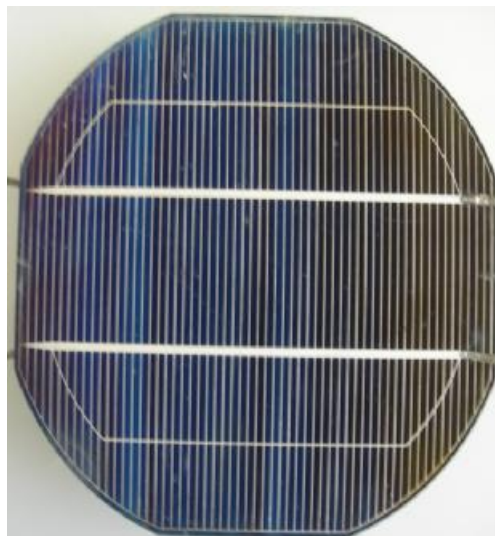
Εικόνα 4.5: c-Si στοιχείο 11cmX11cm (εργαστήριο Α.Π.Ε., ΤΕΙ Πάτρας).
