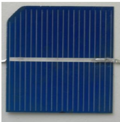
Εικόνα 4.10: Φ/β στοιχείο τύπου sc-Si διαστάσεων 5cmX5cm (εργαστήριο Α.Π.Ε., ΤΕΙ Πάτρας)
