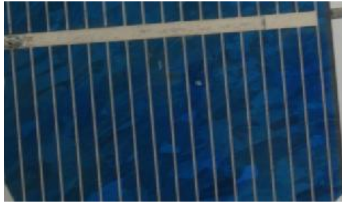
Εικόνα 4.4: pc-Si στοιχείο 6cmX6cm (εργαστήριο Α.Π.Ε., ΤΕΙ Πάτρας).
