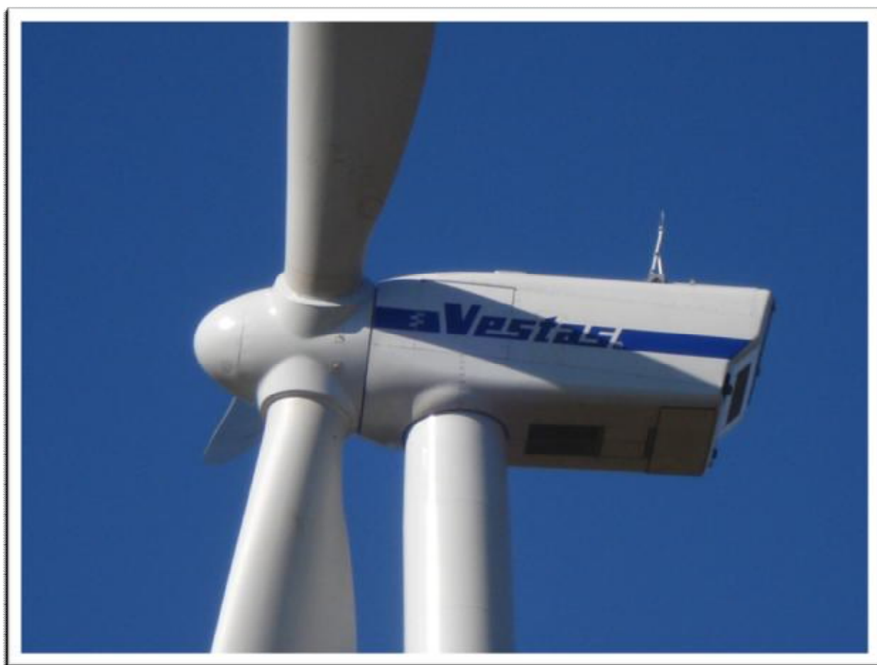
Εικόνα 17: Ανεμογεννήτρια τύπου Vestas V-90 (2Mw)
