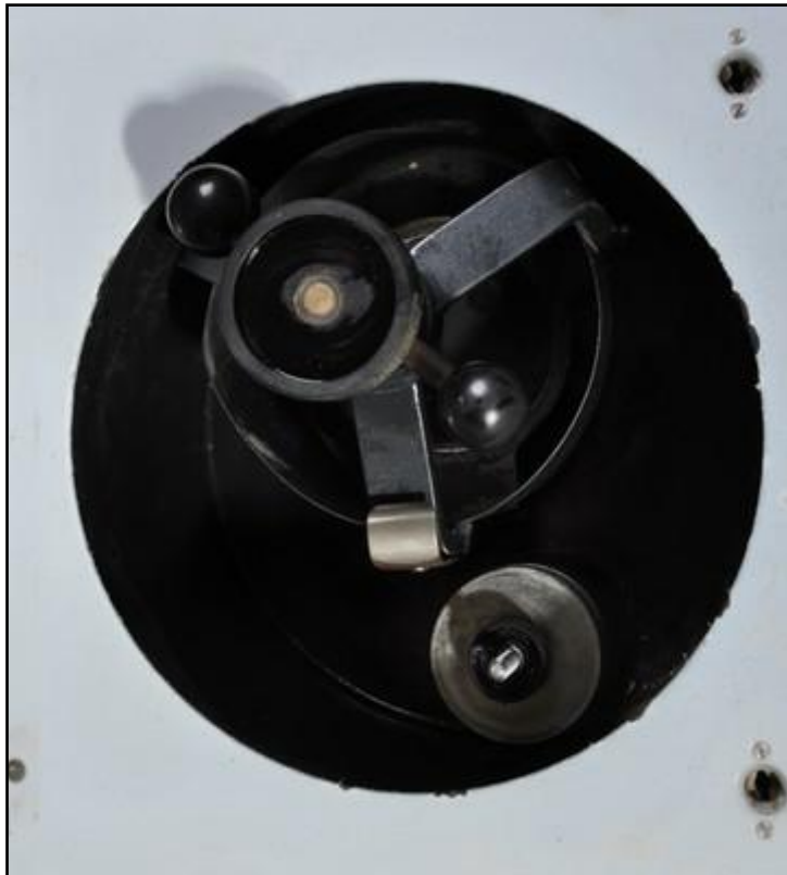
Σχήμα 5: Το εσωτερικό του πλανητικού σφαιρόμυλου τύπου S1(Planetary ball mill).
