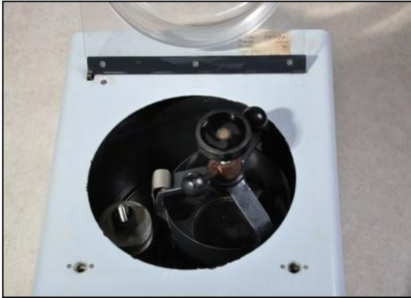
Σχήμα 6: Το εσωτερικό του πλανητικού σφαιρόμυλου τύπου S1 (Planetary ball mill). Ξεχωρίζουν οι δύο εσωτερικές μπάλες.
