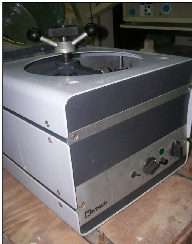
Σχήμα 7: Ο πλανητικός σφαιρόμυλος (Planetary ball mill) τύπου S1, σε χρήση στο εργαστήριο.
