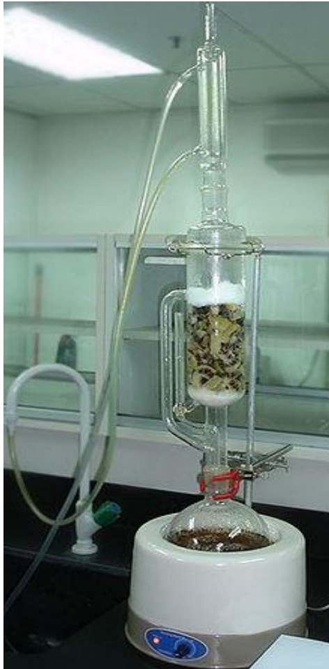
Σχήμα 12: Απεικόνιση του εργαστηριακού οργάνου του απαγωγέα Soxhlet.
