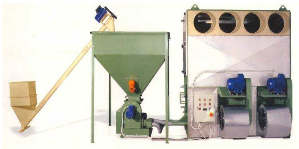
Εικόνα 5.6 : Αερολέβητας πυρηνόξυλου για θερμοκήπια
