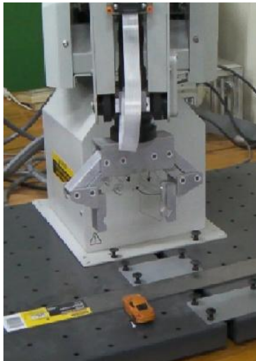
Εικόνα 5-5 Η αρπάγη ανοίγει ώστε να παραλάβει το όχημα.
