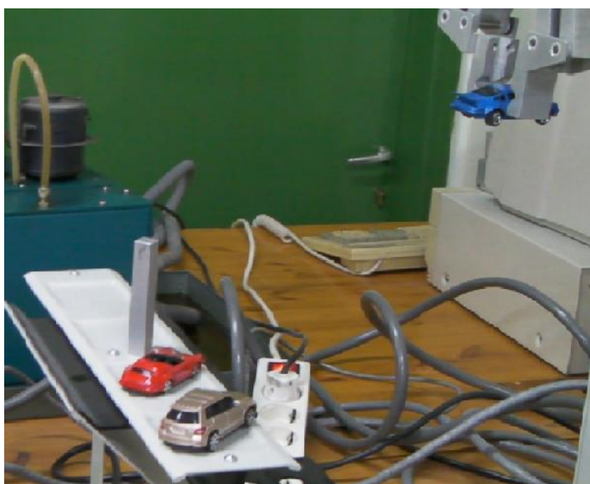
Εικόνα 5-4 Ο ρομποτικός βραχίονας αναλύει τα δεδομένα από το σύστημα για να εντοπίσει την πρώτη κενή θέση που υπάρχει.
