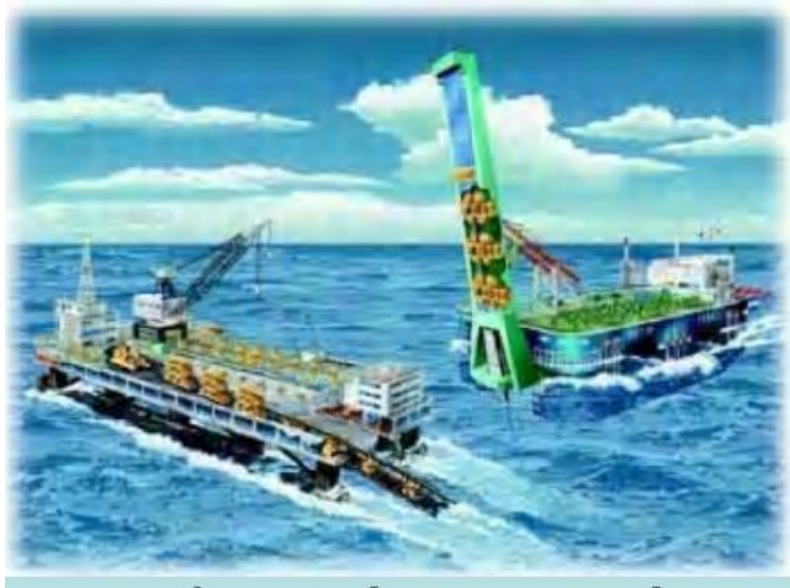
Εικόνα 3.1 Εγκατάσταση υποθαλάσσιου σταθμού.
