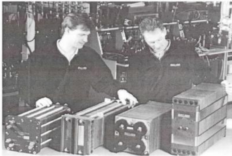
Σχήμα 4.1: Τέσσερις στιβάδες κυψελών καυσίμου PEM που απεικονίζουν την ανάπτυξη το 1990.
