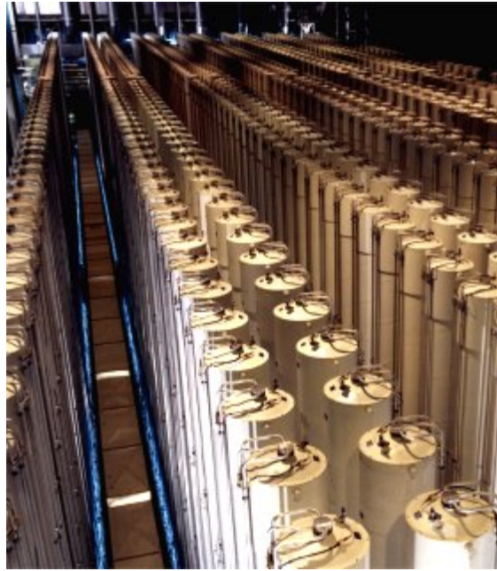
Εικόνα 2.7 Συστοιχία εκατοντάδων διαχωριστήρων για την παραγωγή εμπλουτισμένου ουρανίου με φυγοκέντρηση αερίου.
