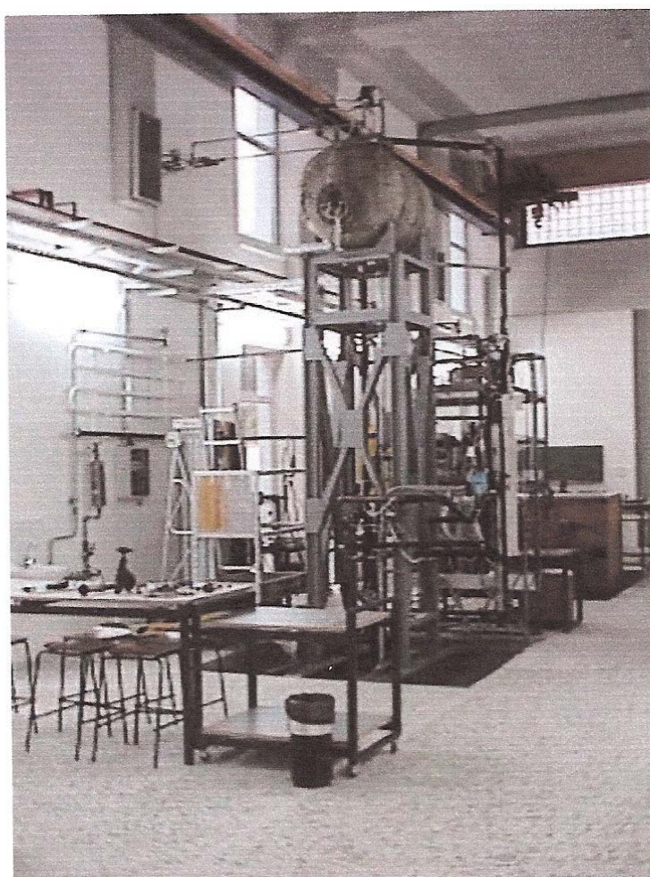
Εικόνα 4.1 Το θερμοϋδραυλικό κύκλωμα του ΕΜΠ με εργαζόμενο μέσο νερό στο οποίο είναι δυνατή η πλήρης προσομοίωση της θερμοϋδραυλικής συμπεριφοράς του ψυκτικού κατά την ψύξη μιας από τις ράβδους του πυρήνα ενός πυρηνικού αντιδραστήρα ισχύος σε όλες τις συνθήκες διαφασικής ροής νερού-ατμού, σε πιέσεις έως 7 bar [9].
