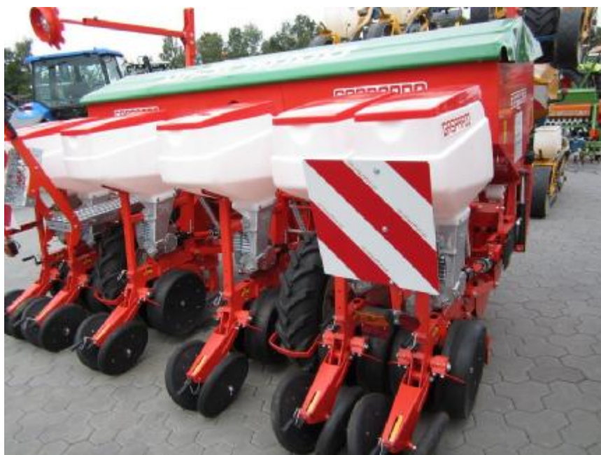
Εικόνα 35: Σπαρτική μηχανή χειμωνιάτικων σπόρων γραμμικής σποράς
