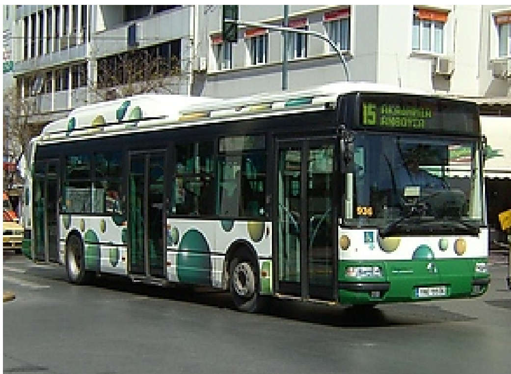
Εικόνα 5. 3 : Λεωφορείο φυσικού αερίου Iris bus με κινητήρα EEV
