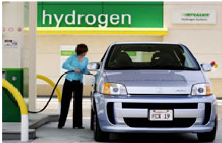
Εικόνα 5. 7 : Όχημα εσωτερικής καύσης με υδρογόνο
