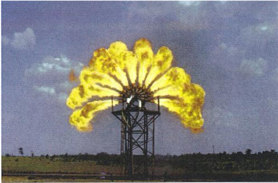
Εικόνα 34: Δοκιμή καύσης σε καπνοδόχο υγρών με ρυθμό 150 gr/min.
