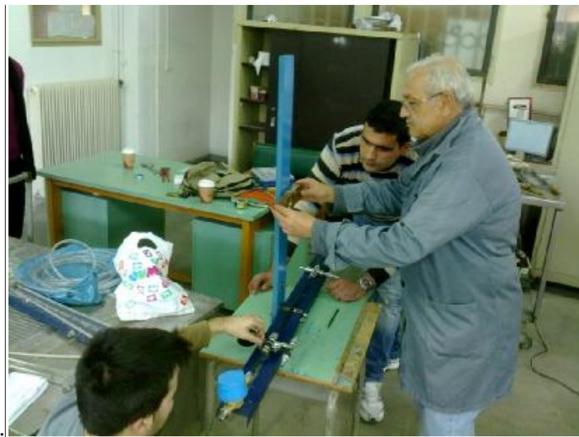
Εικόνα 3.18: Η πειραματική μας συσκευή πρέπει να έρθει σε ισορροπία γι αυτό χρησιμοποιούμε το αλφάδι.
