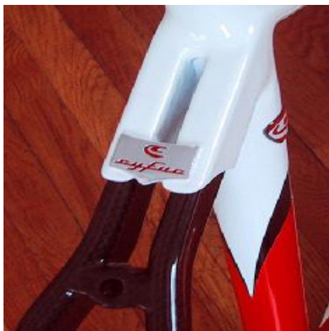
Εικόνα 1.3.2. Παράδειγμα σκελετού με dualstay seatstays
