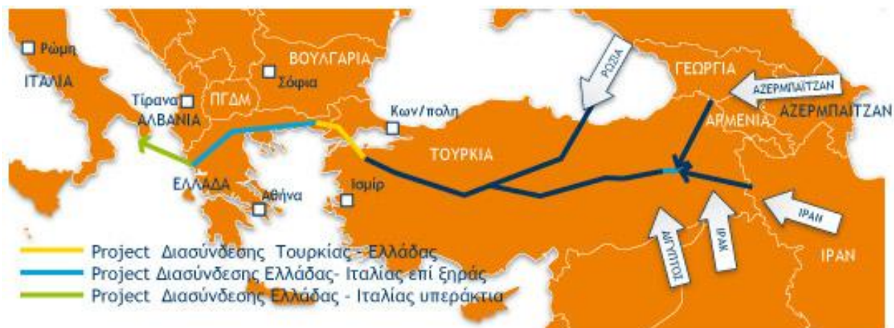
Εικόνα Νο. 5 – Ελληνο-Ιταλικός Αγωγός Μεταφοράς Φυσικού Αερίου Πηγή: Διαχειριστής Εθνικού Συστήματος Φυσικού Αερίου Α.Ε.
