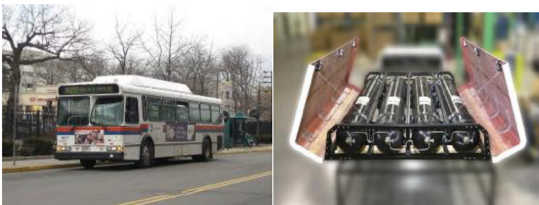
Εικόνες 4.19: Σημείο τοποθέτησης δεξαμενών σε λεωφορείο
