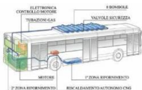
Σχήμα 4.4: Σημείο τοποθέτησης δεξαμενών σε λεωφορείο CNG
