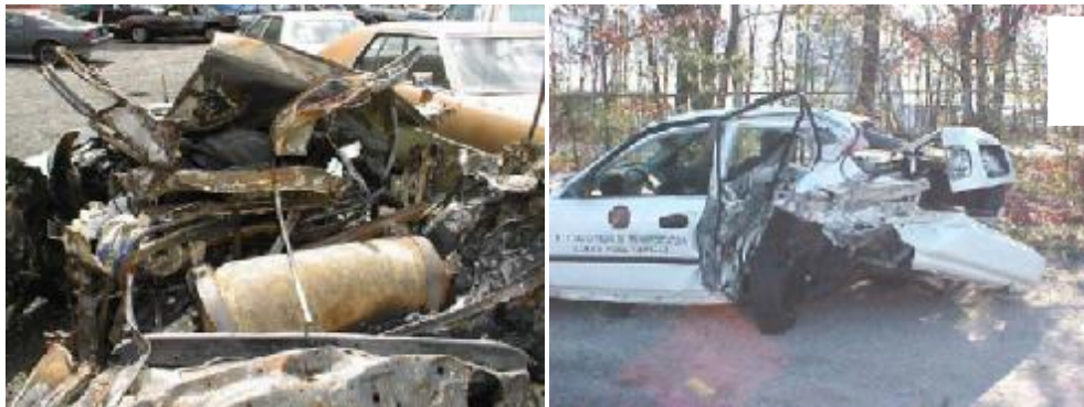
Εικόνες 4.21: (α) Δεξαμενή σε αυτοκίνητο που τράκαρε περίπου με 80 χιλιόμετρα ανά ώρα Υπήρξε πυρκαγιά από το ρεζερβουάρ βενζίνης, το αέριο εκτονώθηκε από την βαλβίδα, δεν υπήρξε έκρηξη (β) Το αυτοκίνητο τράκαρε σε κολώνα δεν υπήρξε ρήξη δεξαμενής η διαφυγή αερίου.
