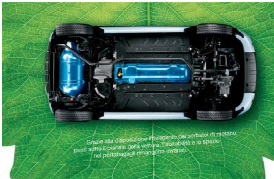
Εικόνα 4.18: Σημεία τοποθέτησης δεξαμενών στο μοντέλο FIAT PANDA 1.2 CNG
