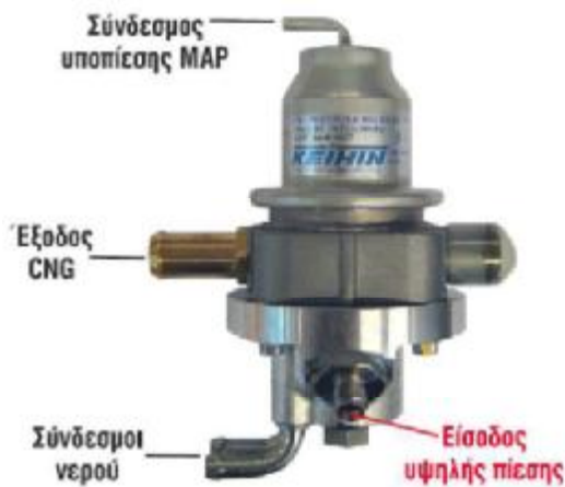
Εικόνα 4.7: Ρυθμιστής πίεσης καυσίμου CNG
