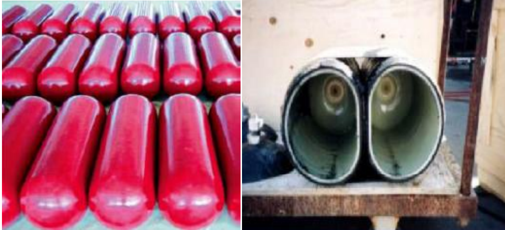
Εικόνες 4.17: Απεικόνιση δύο τύπων δεξαμενών (α) δεξαμενές τύπου 3 (β) Δεξαμενές τύπου 4 πλαστικά αεροστεγής χιτώνιο ενισχυμένο με συνθετικά υλικά γύρω από ολόκληρη την δεξαμενή ("πλήρης τυλιγμένο")
