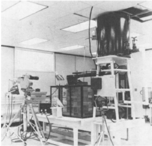
Εικόνα 2-36: Συσσκευή για το test μοντέλου σταδίων αξονικής ροής
