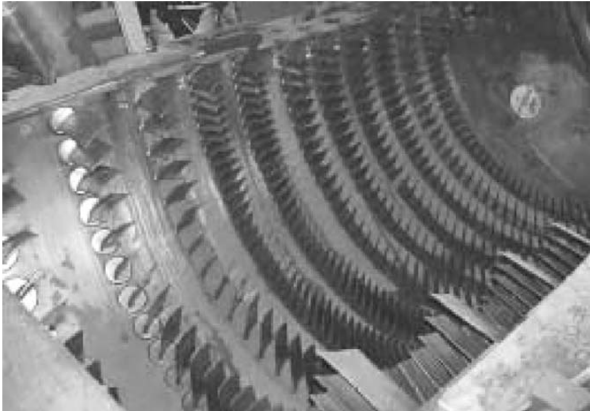
Εικόνα 2-3: Στάτορες συμπίεστή αξονικής ροής τοποθετημένοι σε θήκη
