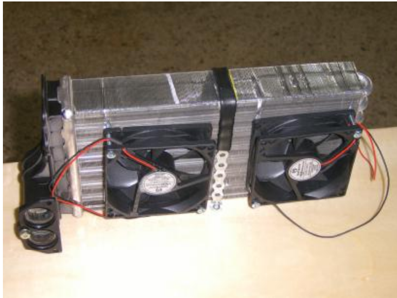
Εικόνα 42: Σύνδεση ανεμιστήρων σε σειρά
