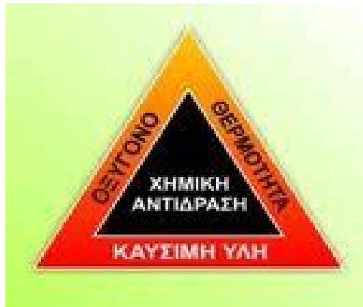
Εικόνα 2.1.: Στο σχήμα απεικονίζεται το τρίγωνο της φωτιάς και φαίνονται ξεκάθαρα τα τρία στοιχεία του.
