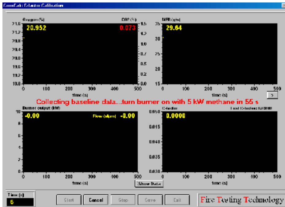
Εικόνα 3.25 : Διαδικασία βαθμονόμησης C κατά το πρώτο στάδιο
