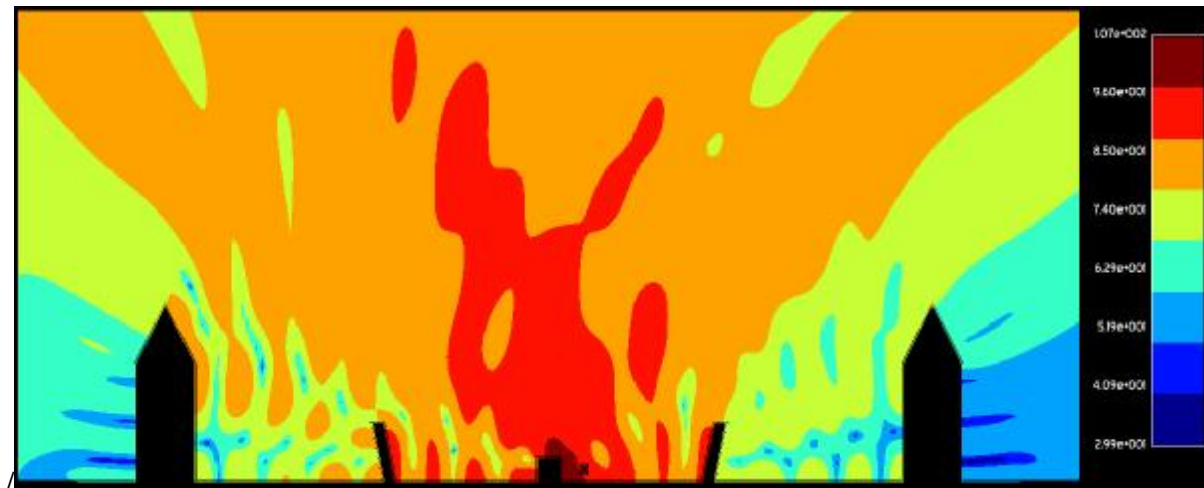
Σχήμα 3.4: Συχνότητα 50Hz: ηχοπετάσματα κεκλιμένα 11° προς τις κατοικίες, μείωση θορύβου κατά 26%
