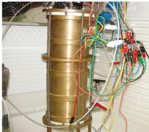
Εικόνα 6.2.: Στατήρας που περιβάλλει και που υποστηρίζει το λαστιχένιο μανδύα με τα καλώδια σύνδεσης των ηλεκτροδίων με το μετρητή αγωγιμότητας.
