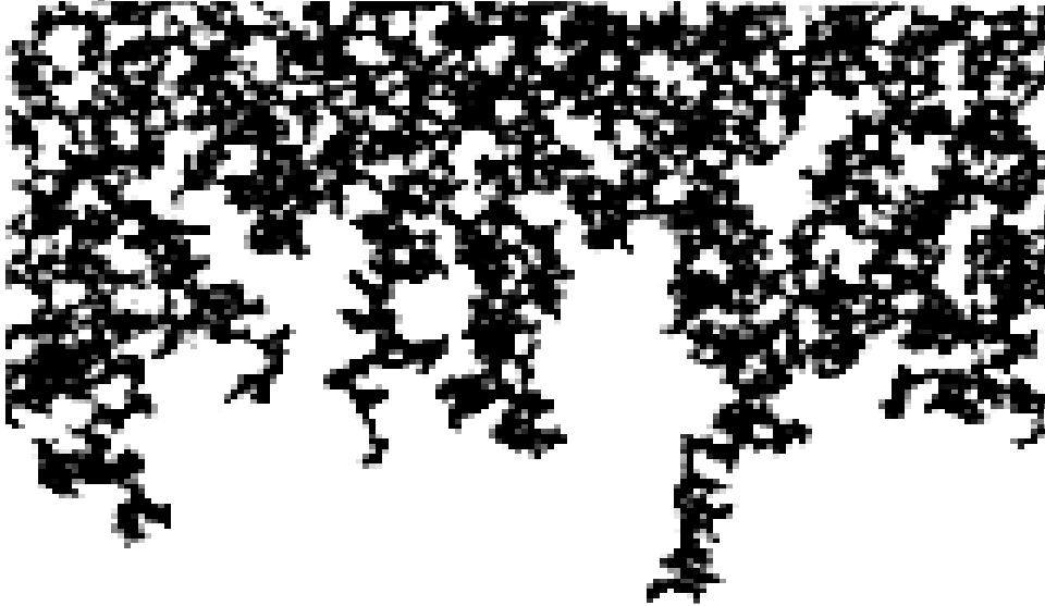
Εικόνα 1.3.: Μη αναμίξιμη εκτόπιση υδατικής (άσπρο) από μη υδατικής φάσης (μαύρο). (β) Σχηματισμός τριχοειδών δακτύλων (capillary fingering)
