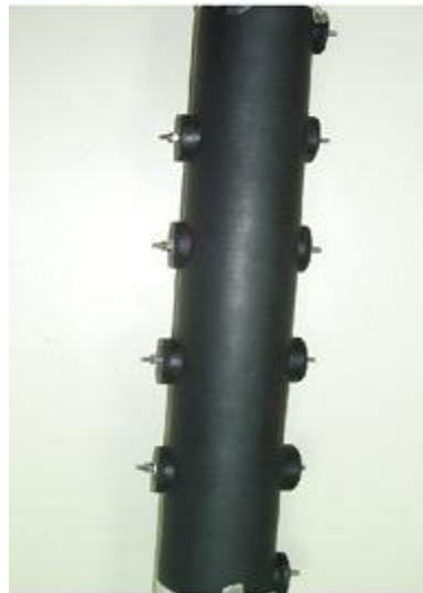
Εικόνα 6.1.: Λαστιχένιο μανίκι που περιέχει τη στήλη αδιατάραχτου χώματος (με ζευγάρια ράβδων ηλεκτροδίων).
