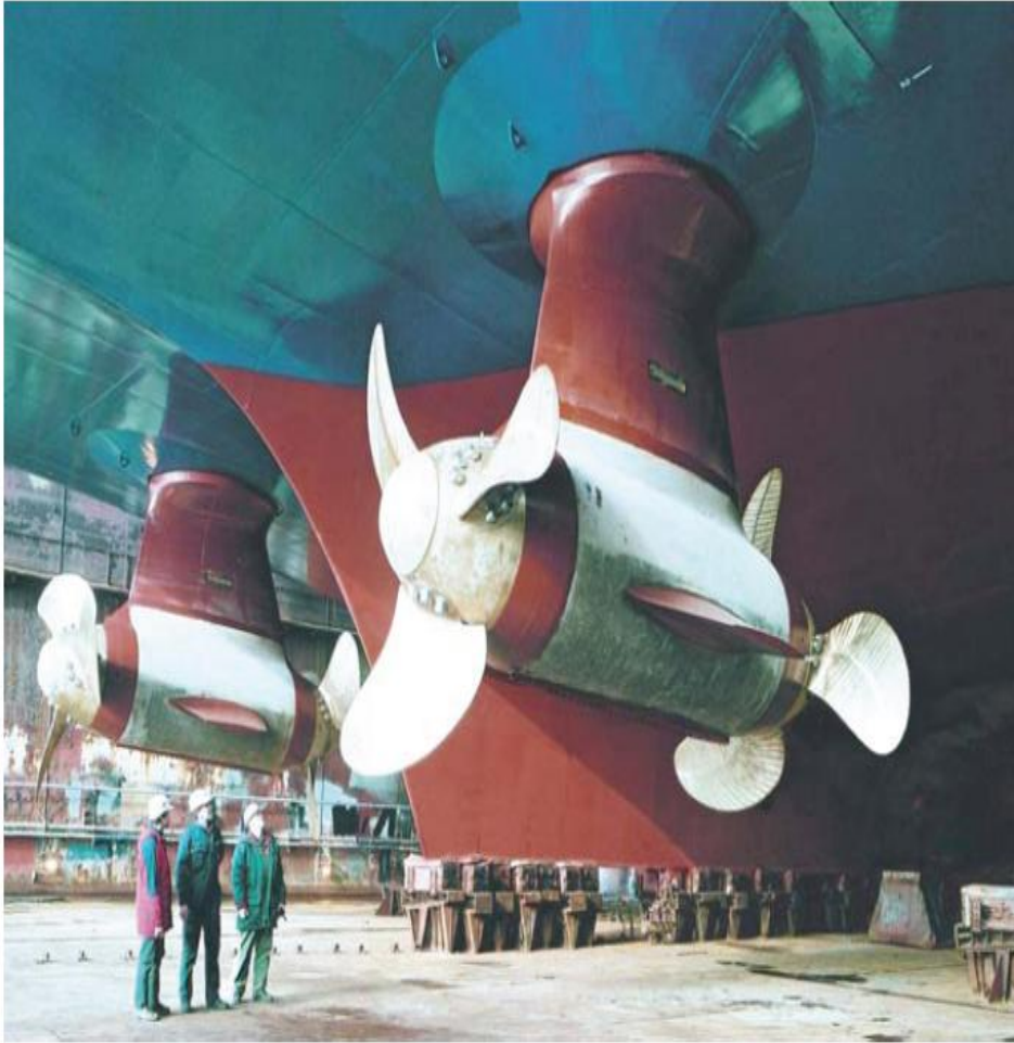
Σχήμα 3.12: Στο εικονιζόμενο σύστημα οι έλικες μεταβλητού βήματος περιστρέφονται κατά την ίδια φορά
