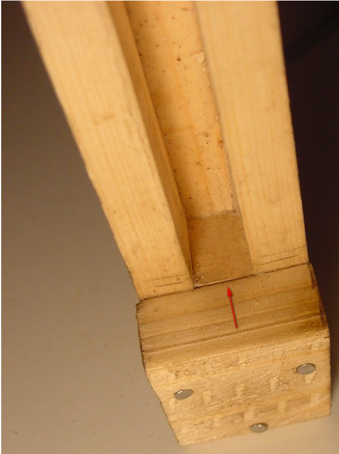
Εικόνα 3.12: Το διάκενο (flue) μεταξύ κάτω χείλους και γλώσσας του αυλού
