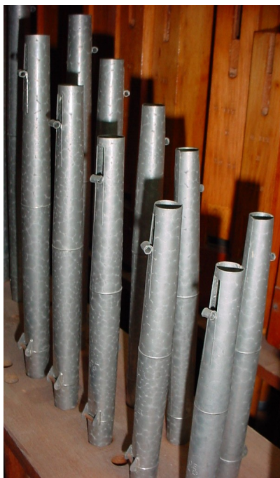
Εικόνα 2.34: Ανοικτοί μεταλλικοί αυλοί, με κόψιμο στο πλάι του αυλού ( scroll tuner ). Οι συγκεκριμένοι αυλοί ανήκουν στον τύπο Orchestral oboe [42]
