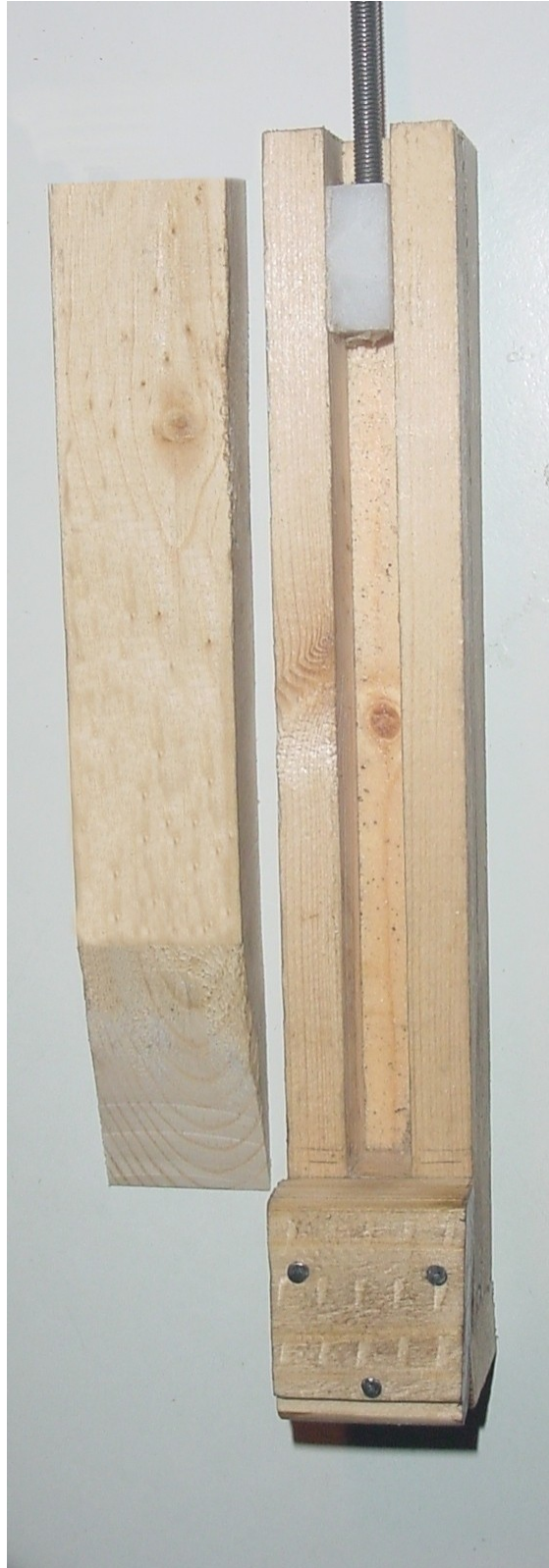
Εικόνα 3.10: Χειροφόωνος αυλός χωρίς την εμπρόσθια λωρίδα ξύλου και με τοποθετημένο το αντικείμενο για την ρύθμιση του μήκους της στήλης αέρα
