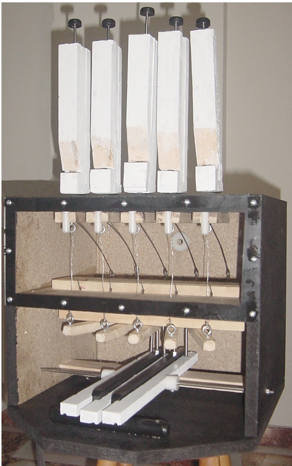
Εικόνα 3.13: Το μοντέλο οργάνου στην τελική του μορφή με τοποθετημένους όλους τους αυλούς του, με τοποθέτηση πλεξιγκλάς στο εμπρόσθιο τμήμα της αεροδόχου και με σπή στο πίσω μέρος της για την εισαγωγή του πεπιεσμένου αέρα
