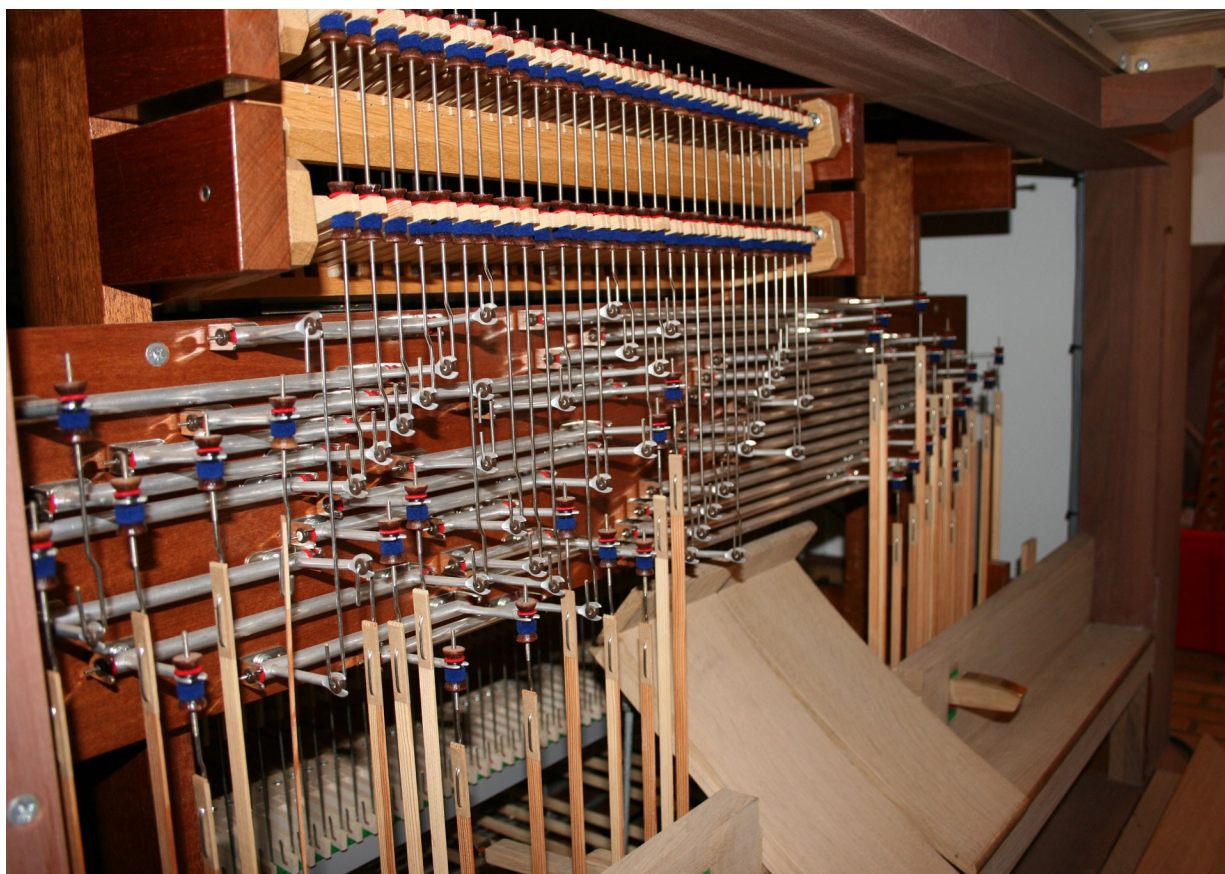
Εικόνα 2.43: Η εσωτερική διάταξη ενός συστήματος μετάδοσης κίνησης μηχανικής λειτουργίας
