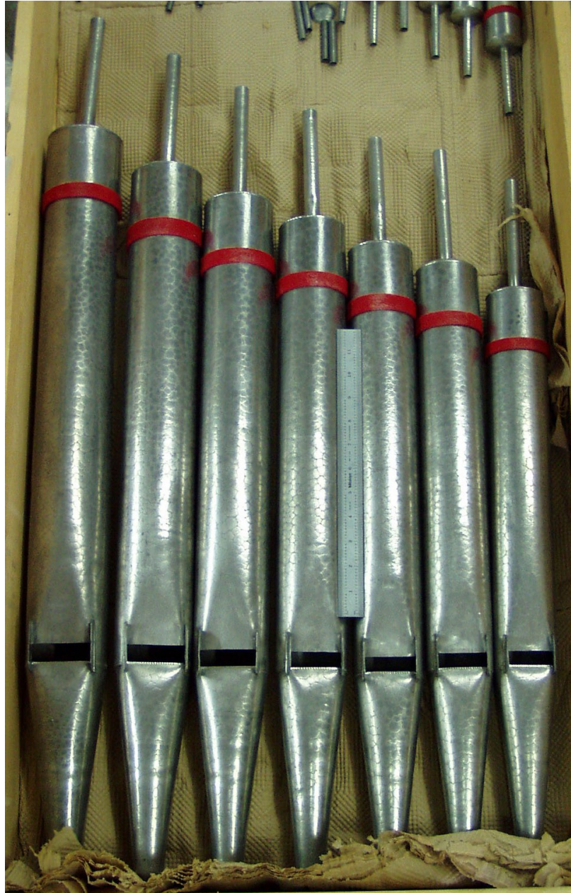
Εικόνα 2.36: Αυλοί με εμφάνιση κυκλικών σιγμάτων λόγω της ίδιας αναλογίας κασσίτερου – μολύβδου
