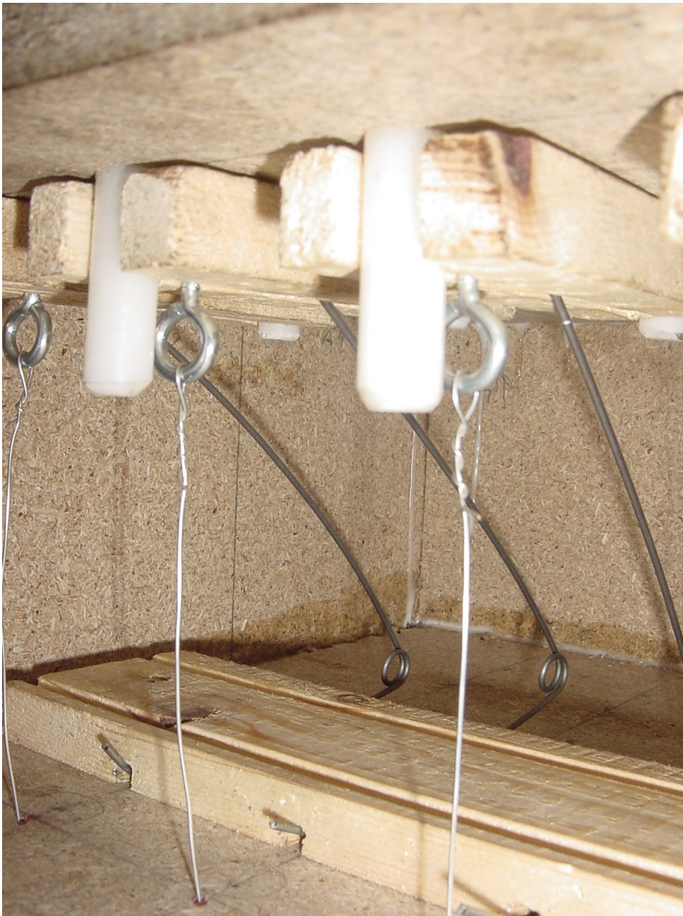
Εικόνα 3.3: Η συγκράτηση των παλετών στην θέση τους με ελατήρια στρέψεως και η ευθυγράμμισή τους με την βοήθεια πέρων ως οδηγών κατά την κίνησή τους
