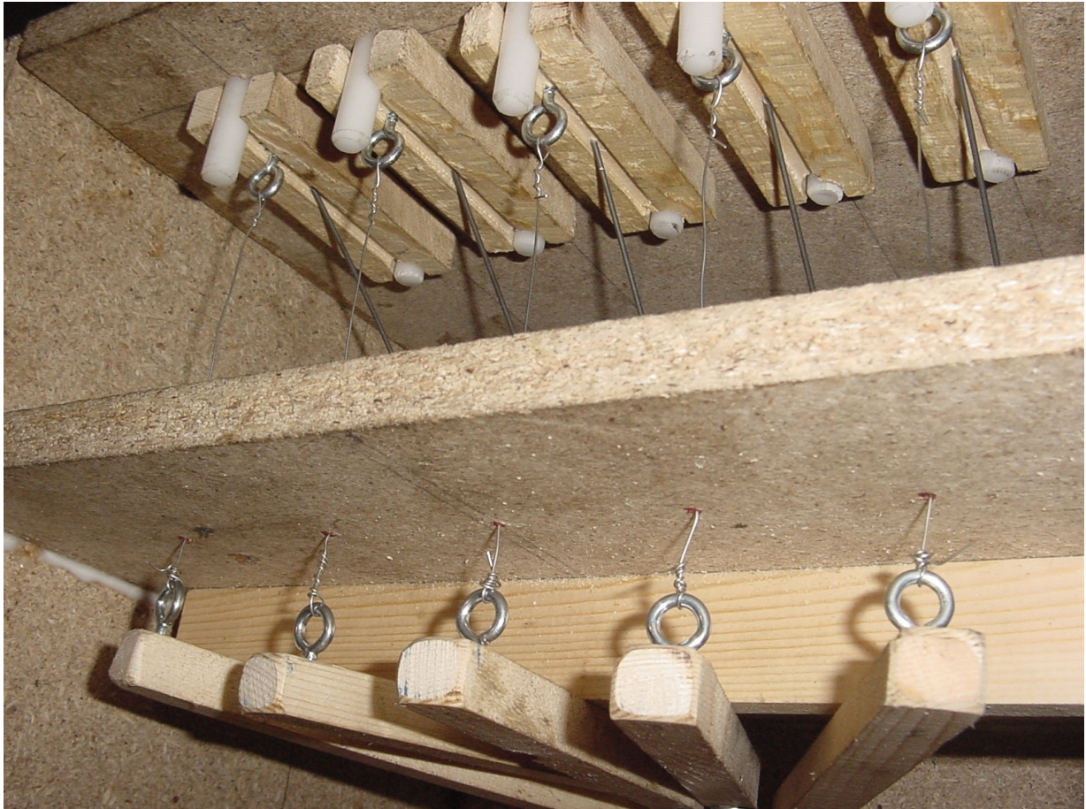
Εικόνα 3.5: Η σύνδεση με σύρμα κάθε οριζόντιας ράβδου (backfall) με την αντίστοιχη παλέτα (pallet) για την μετάδοση της κίνησης
