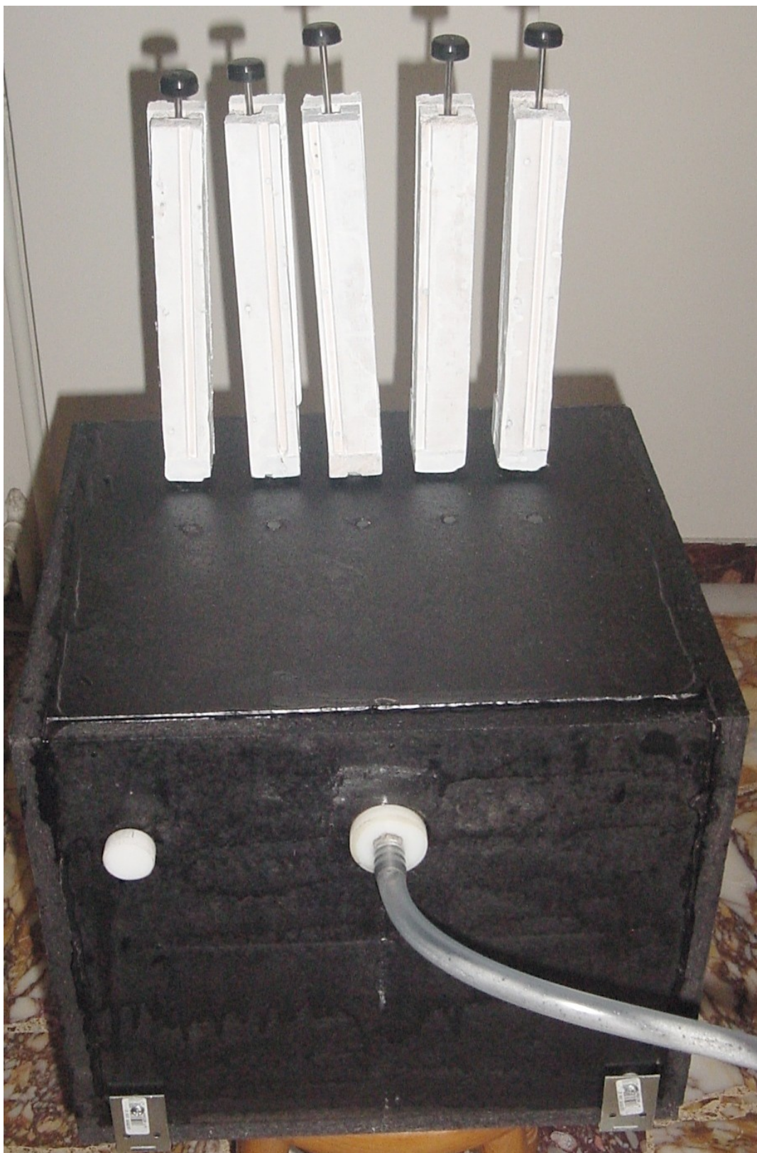
Εικόνα 3.14: Το πίσω μέρος του οργάνου, στην τελική του μορφή, όπου φαίνεται η σύνδεση του σωλήνα παροχής αέρα στην οπή του πίσω τμήματος της αεροδόχου
