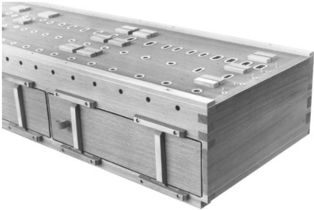
Εικόνα 2.12: Αεροδόχος, χωρίς την τοποθέτηση όλων των τμημάτων, στην οποία φαίνονται οι οπές τοποθέτησης των ποδιών των αυλών
