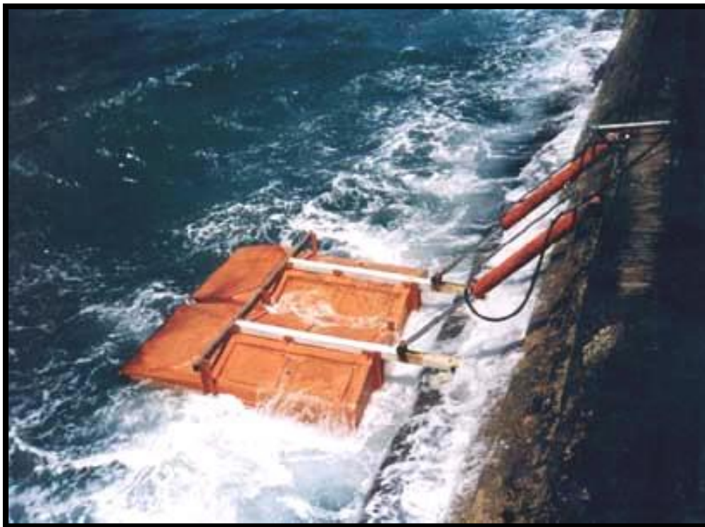
Εικόνα 5:Συσκευή SDE σε κυματοθραύστη
