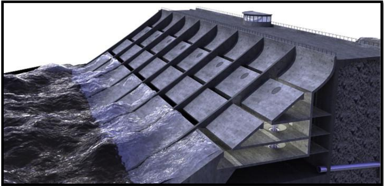
Εικόνα 9: Σύστημα SSG με τρεις δεξαμενές
