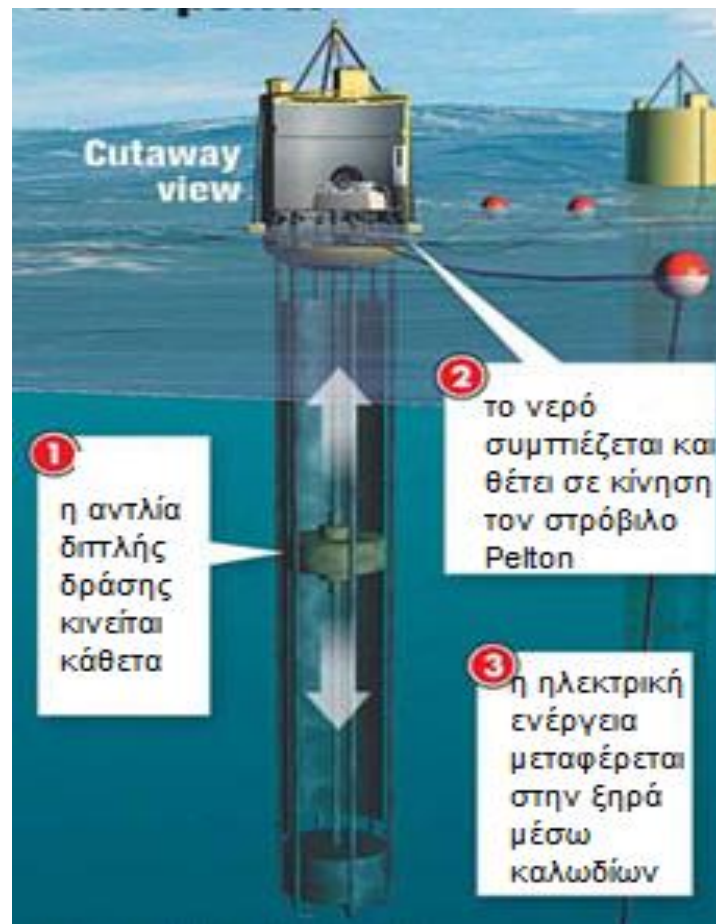
Εικόνα 34: Τρόπος λειτουργίας AquaBuoy
