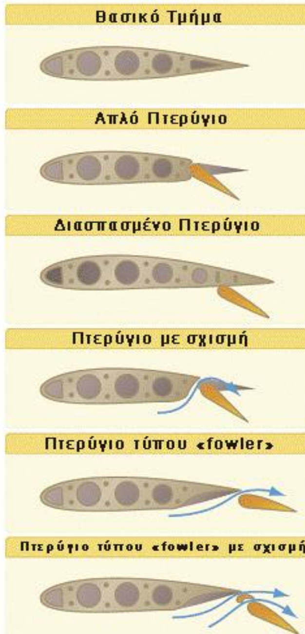
Σχήμα 21: Τύποι πτερυγίων (airstudents.com)
