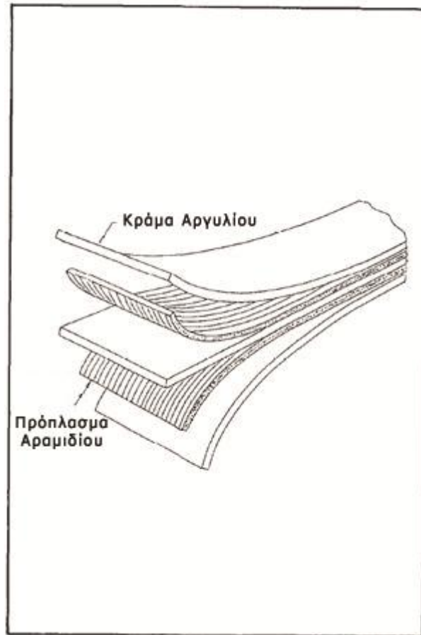
Σχήμα 46: Το υλικό ARALL
