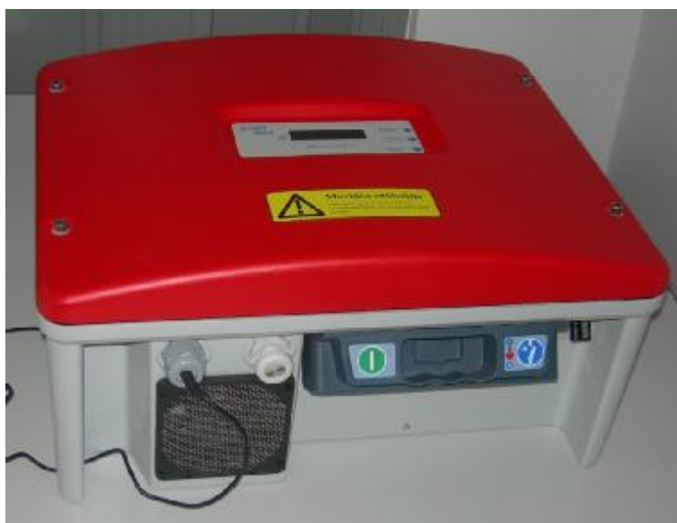
Εικόνα.4.3: Μετατροπέας (inverter). Πηγή:[ Εργαστήριο ΑΠΕ ΤΕΙ Πάτρας.]
