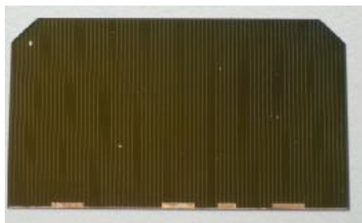
Εικόνα2.3: Φ/β στοιχεία τεχνολογίας λεπτού υμένα. Πηγή: [Εργαστήριο ΑΠΕ, ΤΕΙ Πάτρας]
