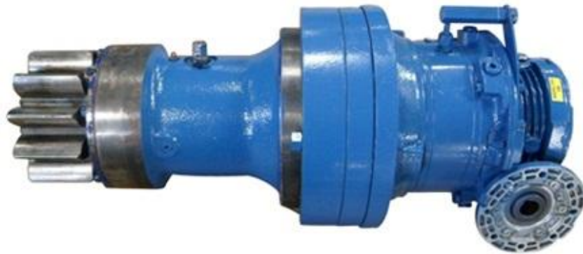
Σχήμα 7.6: Ασύγχρονος ηλεκτρικός κινητήρας συστήματος προσανατολισμού
