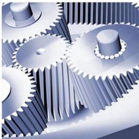
Εικόνα 6.7α: Γρανάζια πλανητικού συστήματος ελικοειδούς μορφής.
