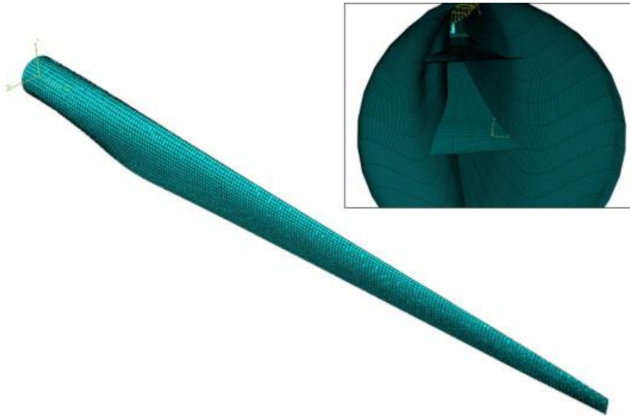
Σχήμα 3.7β: Όψη και τομή πτερυγίου
