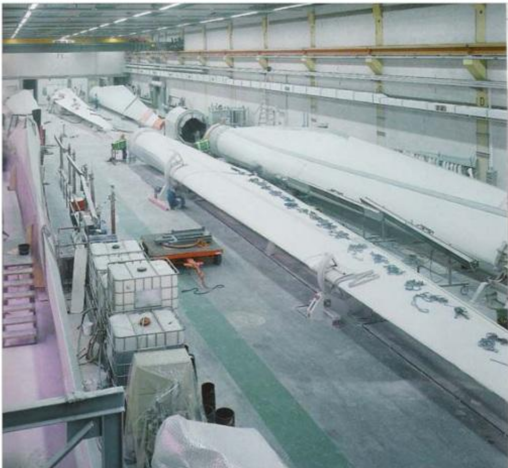
Εικόνα 3.7α: Πτερύγιο κατά την φάση παραγωγής του
