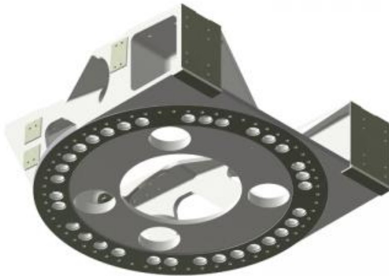
Σχήμα 7.4γ: Πλάκα έδρασης-σκελετός σώματος ΑΙΓ
