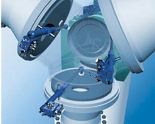
Εικόνα 3.9.γ: Σύστημα ελέγχου κλίσης των πτερυγίων( pitch control) με χρήση σερβοκινητήρων
