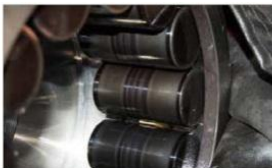
Εικόνα 6.6: Κυλινδρικό έδρανο κύλισης μονής σειράς κιβωτίου ταχυτήτων
