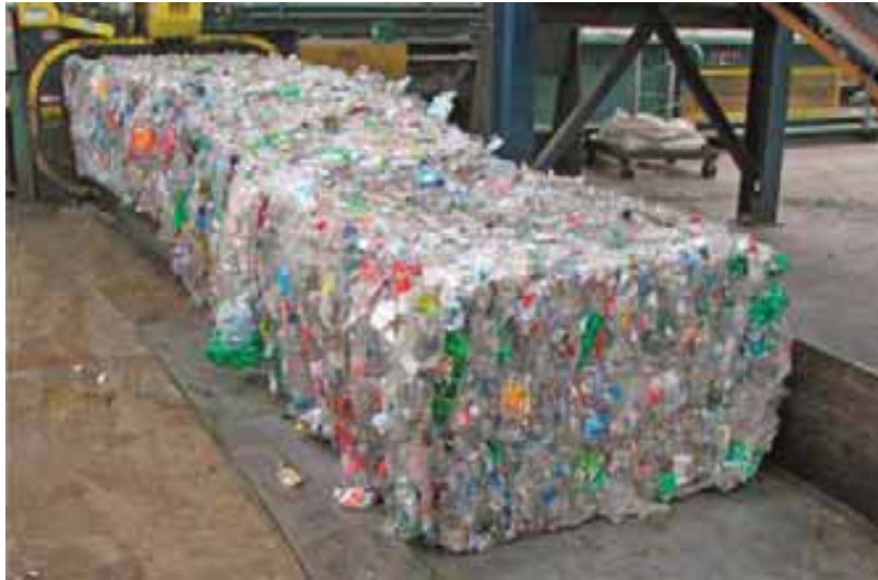
Σχήμα 4.3 Συμπύεση και δεματοποίηση (baling) των ρευμάτων των πλαστικών απορριμμάτων (ανά είδος ή ανά μίγμα) στα ΚΔΑΥ για να οδηγηθούν στις εγκαταστάσεις προ-επεξεργασίας [2].
