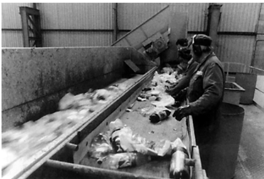
Σχήμα 4.6 Χειρονακτικός διαχωρισμός σε κυλιόμενο μεταφορέα όπου φαίνονται και τα δοχεία συλλογής [2].
