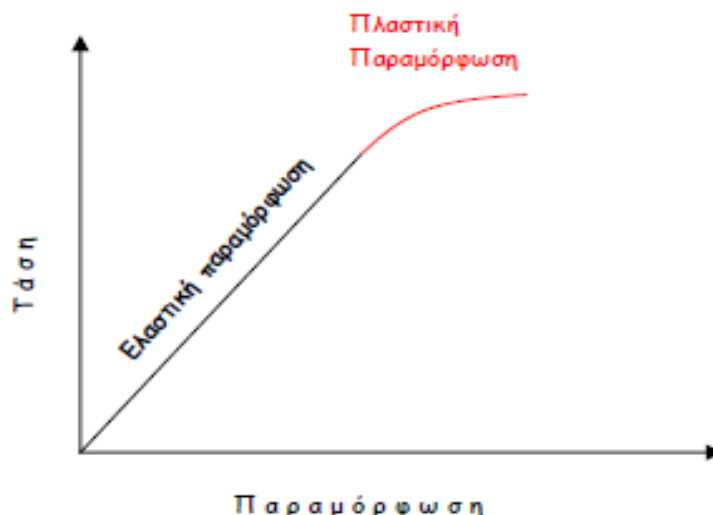
Σχήμα 1.6. :Διάγραμμα τάσης-παραμόρφωσης σε σχέση με την συμπεριφορά του υλικού.
