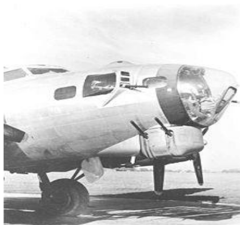
Εικόνα 2.1. :Το διαμέρισμα της μύτης του βομβαρδιστικού είναι κατασκευασμένο από Plexiglas (1943).
