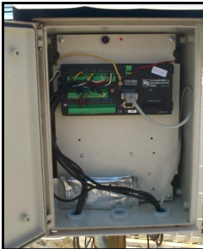
Εικόνα 3.10 : Καταχωρητής ( data logger ) εργαστηρίου ΑΠΕ, ΤΕΙ Πάτρας
