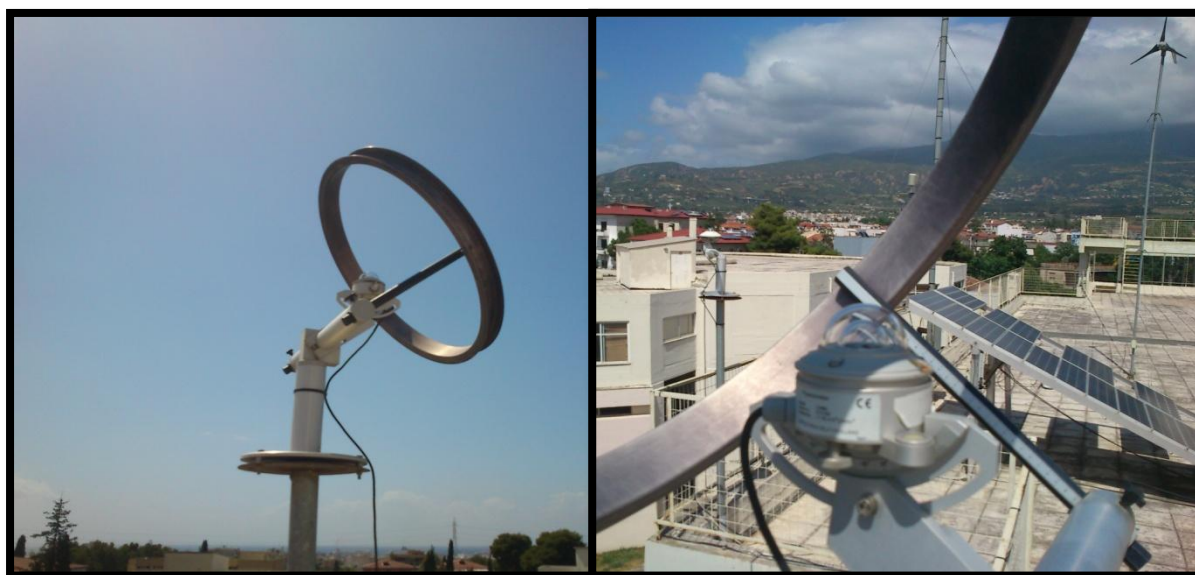
Εικόνα 3.8 και 3.9 : Πυρανόμετρο του εργαστηρίου ΑΠΕ του ΤΕΙ Πάτρας με δακτύλιο σκίασης για την μέτρηση της έντασης της διάχυτης ακτινοβολίας. Στην εικόνα δεξιά φαίνεται η σκίαση που δημιουργείται στον γυάλινο θόλο του οργάνου από τον δακτύλιο
