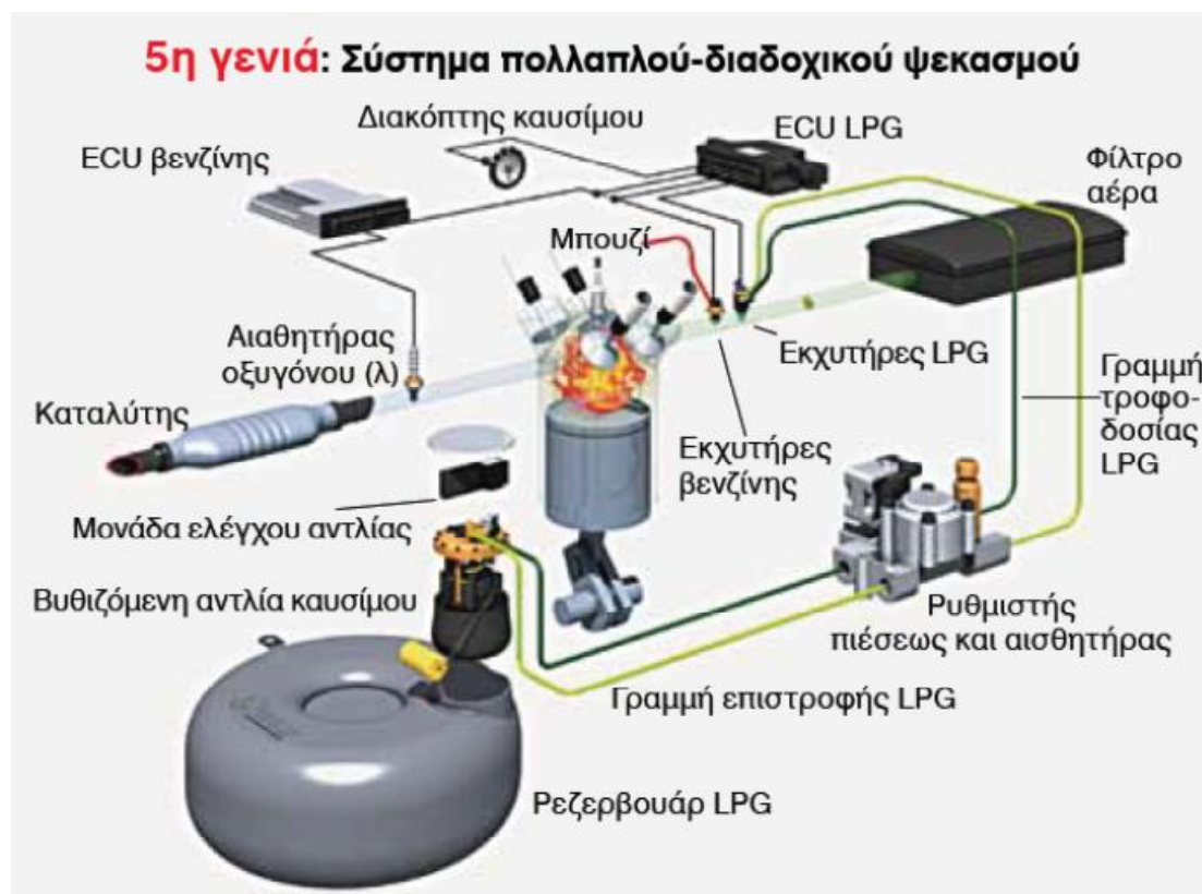
Σχήμα 21: Σύστημα υγραερίου βενζίνης πέμπτης γενιάς
