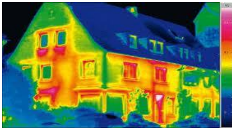
ΕΙΚ. 6.1: Θερμικές απώλειες κατοικίας – μέτρηση με θερμοκάμερα
