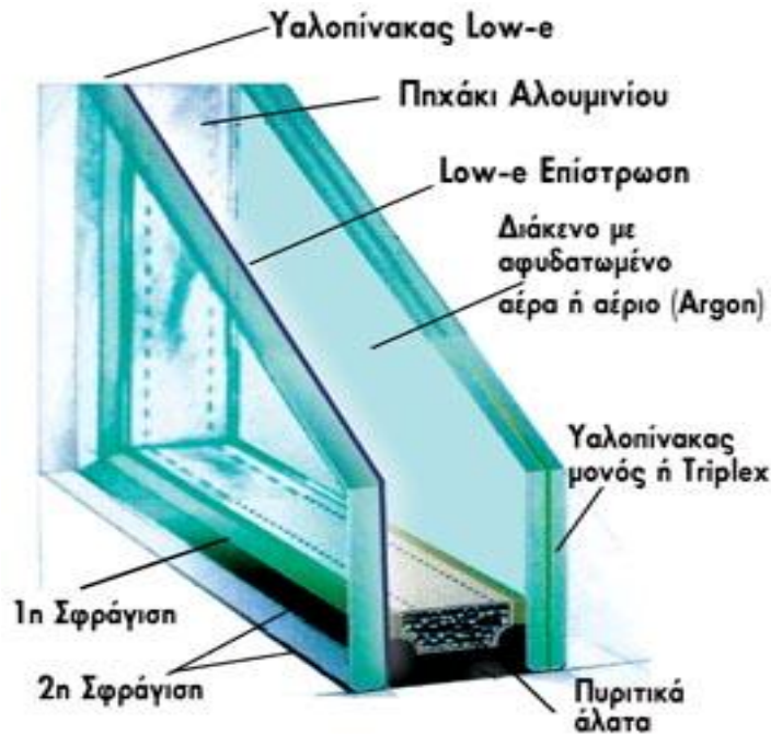
Σχήμα 7.13: Θέση επίστρωσης στα ζεστά κλίματα
