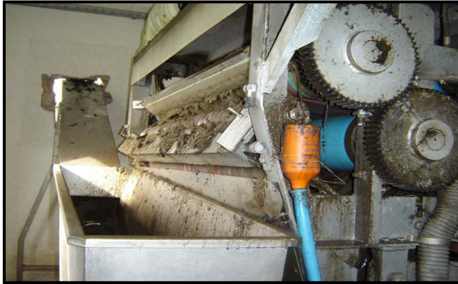
Εικόνα 3.15. Ιλύς σε μηχανή ξήρανσης ( www.google.gr/images )
