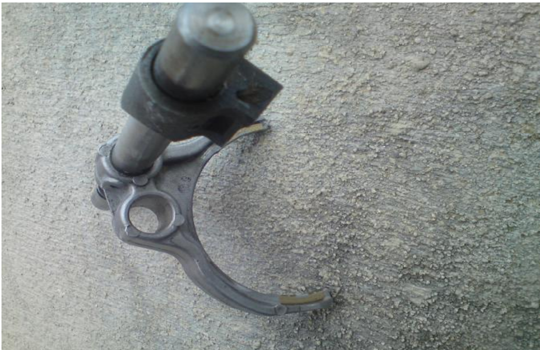
Εικόνα 2.13 Στην παραπάνω εικόνα βλέπουμε μια φουρκέτα σε πλάγια όψη.
