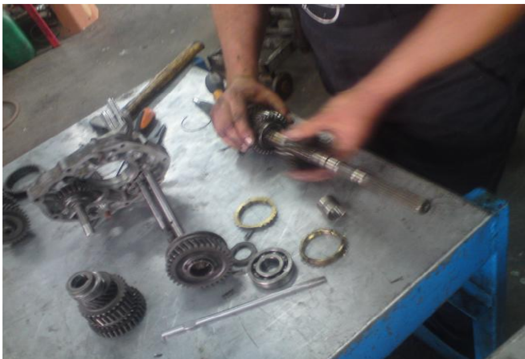
Εικόνα 3.3 Επανατοποθέτηση των γραναζιών του πρωτεύοντα άξονα, ύστερα από πλύση και καθαρισμό με χρήση βενζίνης.
