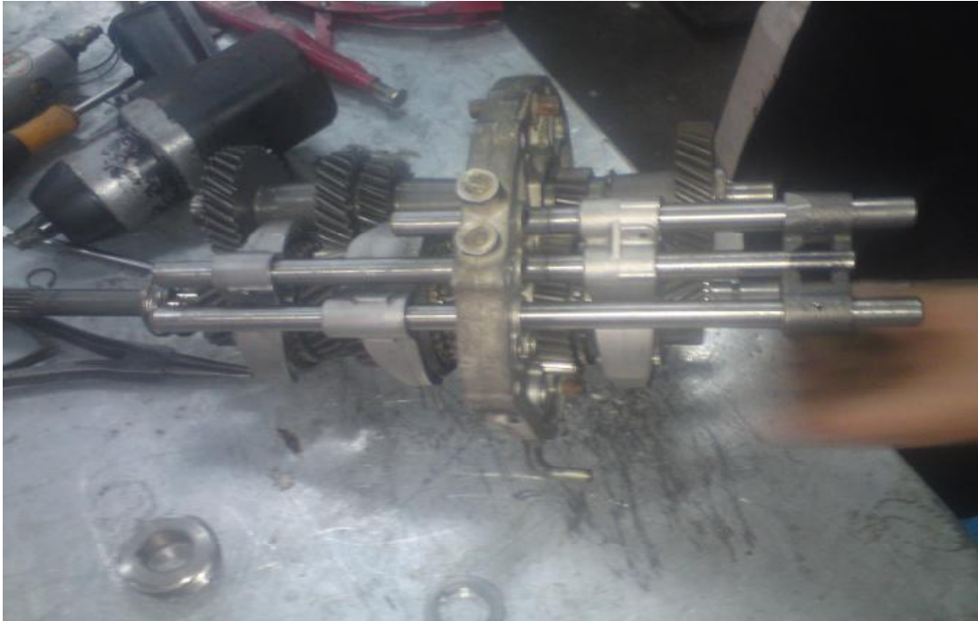
Εικόνα 3.7 Απεικόνιση του κιβωτίου ταχυτήτων με επανατοποθετημένους όλους τους άξονες και τα γρανάζια.
