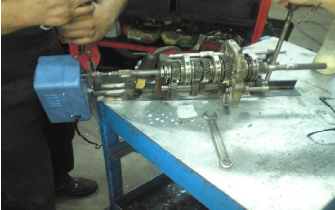
Εικόνα 3.11 Απεικόνιση απο την εργασία συγκόλλησης και ευθυγράμμισης του ηλ. μοτέρ με τον κινητήριο άξονα.
