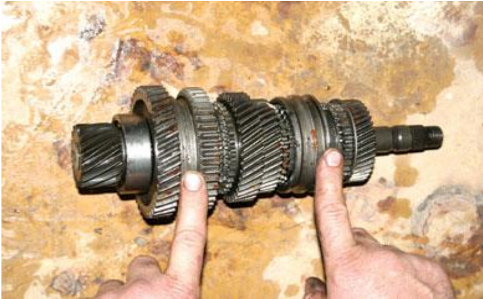
Εικόνα 1.8 Στην παραπάνω εικόνα οι δείκτες δείχνουν τα ‘κόμπλερ’ ανάμεσα στα γρανάζια .
