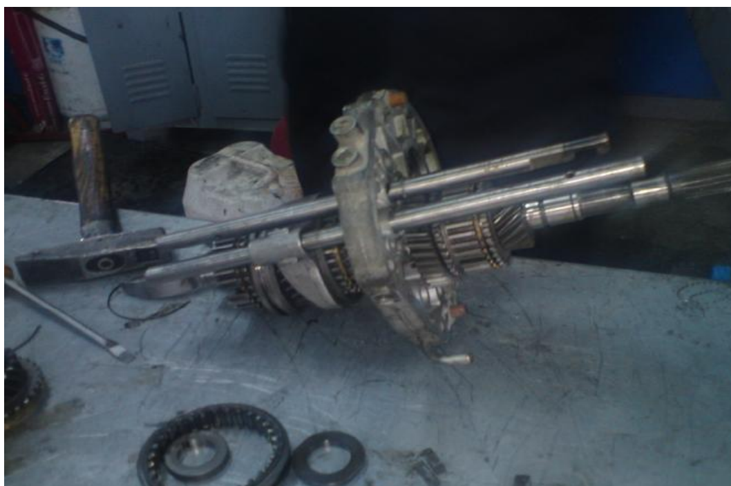
Εικόνα 3.4 Απεικόνιση του πρωτεύον άξονα τοποθετημένο στο διαχωριστικό κάρτερ.
