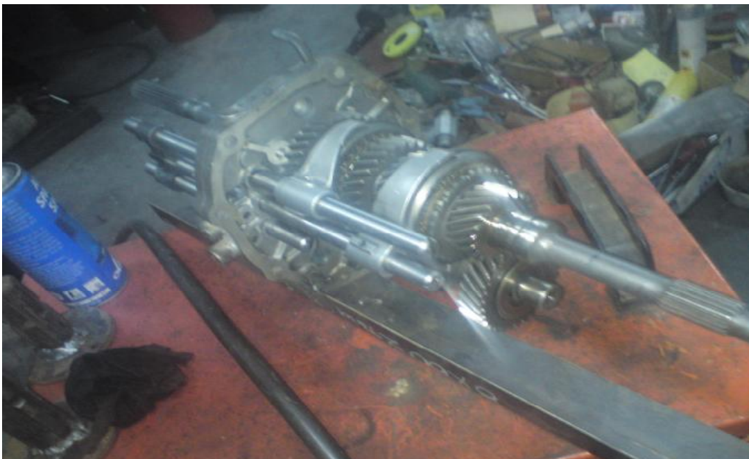
Εικόνα 3.8 Πλάγια όψη κατά την συγκόλληση του διαχωριστικού κάρτερ με την χειροποίητη βάση.
