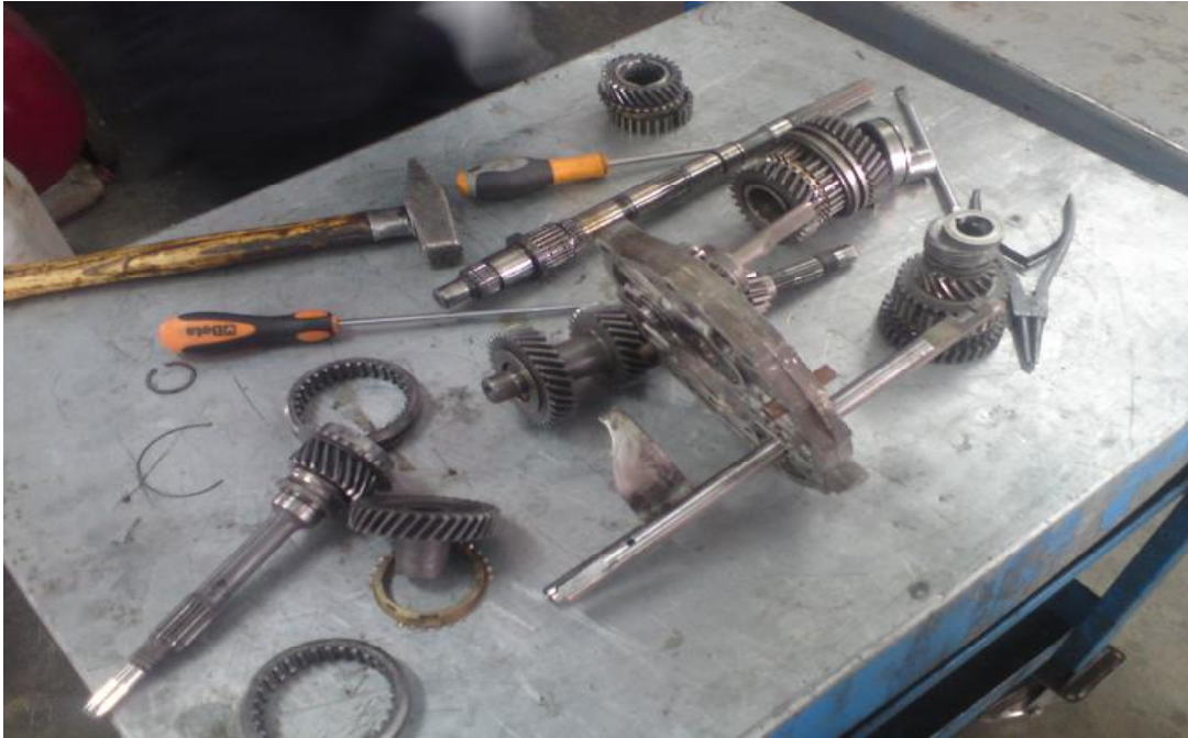
Εικόνα 3.1 Το κιβώτιο κατά την αποσυναρμολόγηση από το διαχωριστικό κάρτερ.
