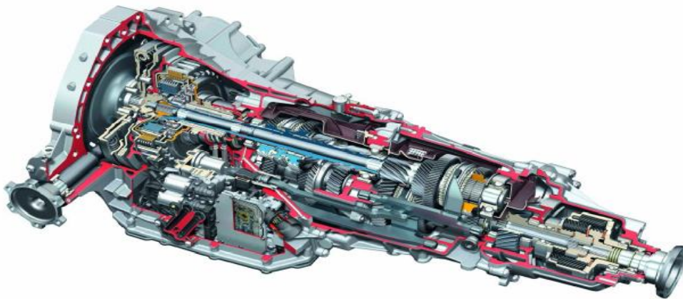
Εικόνα 5.4 Απεικόνιση ενός κιβωτίου S-tronic της AUDI σχεδιασμένο με την ίδια φιλοσοφία.
