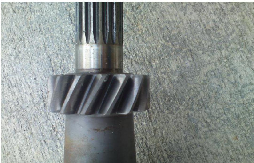
Εικόνα 2.7 Το γρανάζι της πρώτης του πρωτεύον άξονα.
