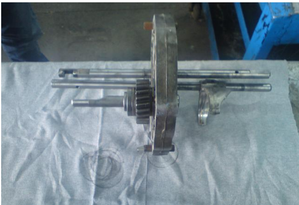
Εικόνα 2.14 Εδώ βλέπουμε το κάρτερ, τις φουρκέτες και τον αναστροφέα της όπισθεν.
