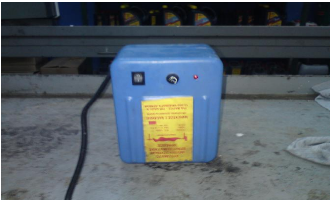
Εικόνα 3.10 Απεικόνιση του ηλεκτρικού μοτέρ, που χρησιμοποιήσαμε ώστε να δοθεί κίνηση στον πρωτεύον άξονα.
