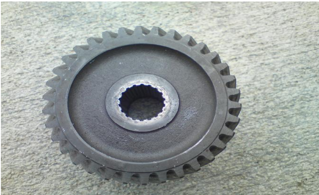
Εικόνα 2.3 Το γρανάζι του πρωτεύον άξονα της πέμπτης ταχύτητας.
