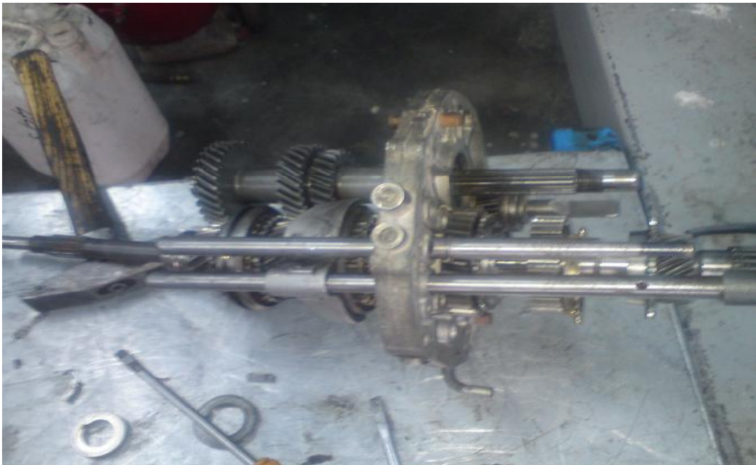
Εικόνα 3.6 Απεικόνιση του διαχωριστικού κάρτερ με τοποθετημένους και τους δύο άξονες.
