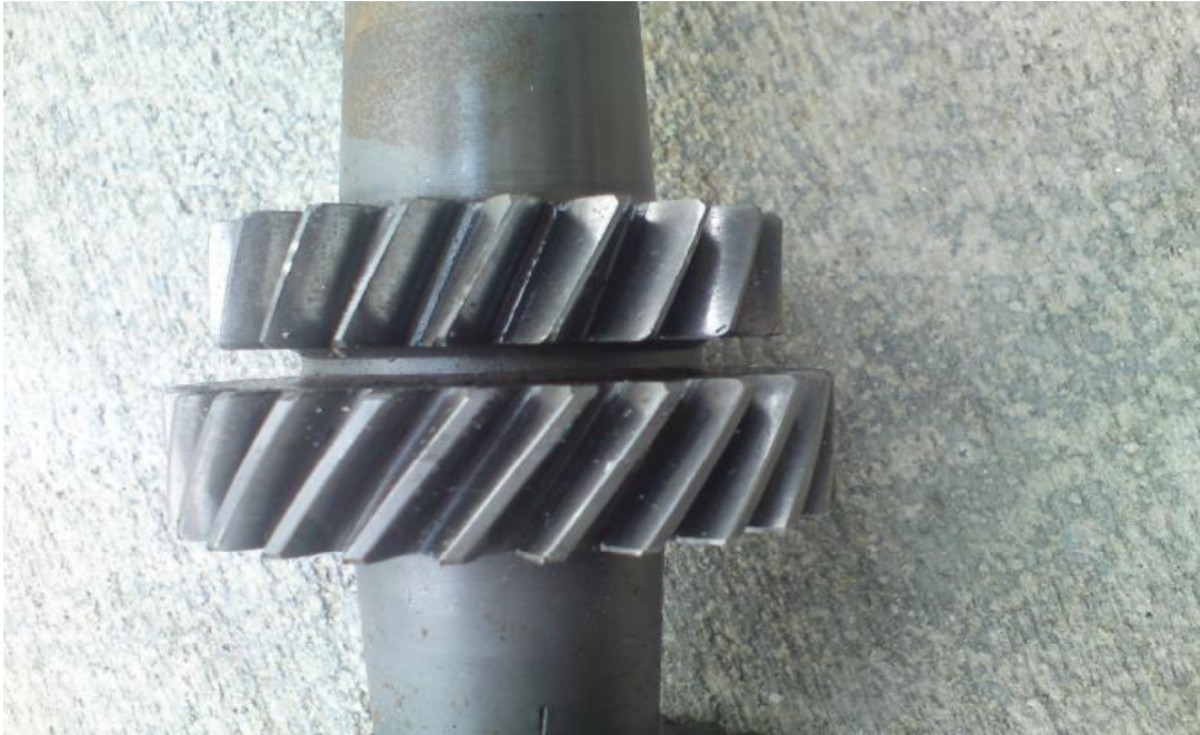
Εικόνα 2.6 Τα γρανάζια της δευτέρας και της τρίτης του πρωτεύον άξονα.
