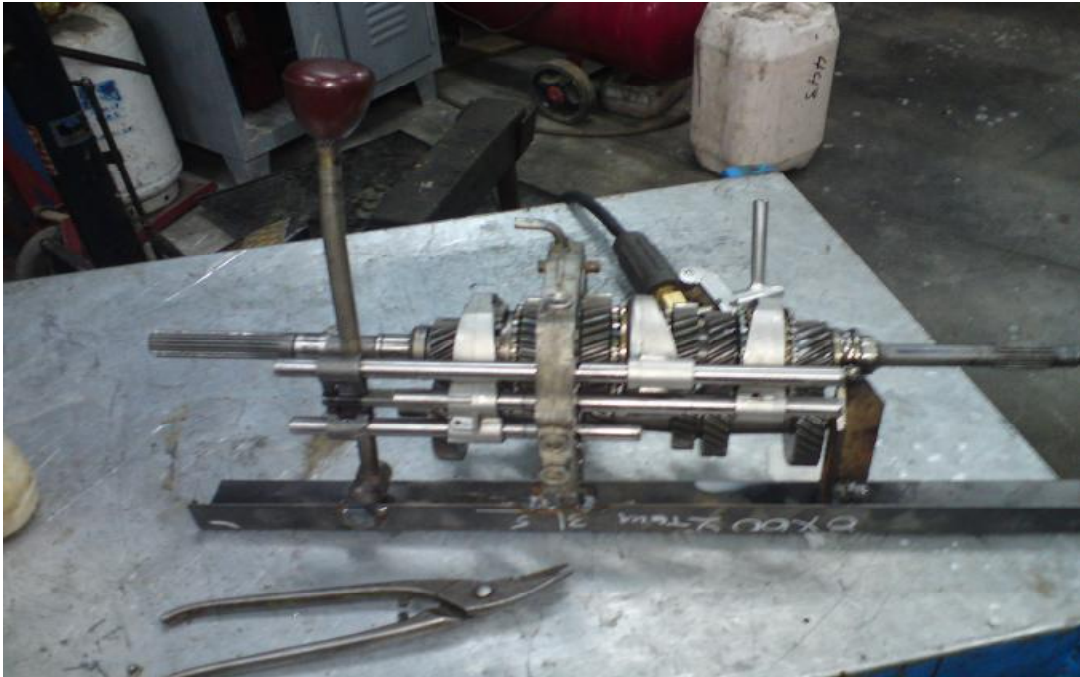
Εικόνα 3.9 Απεικόνιση του κιβωτίου πάνω στην χειροποίητη βάση, έχοντας τοποθετημένο και τον λεβιέ ταχυτήτων.
