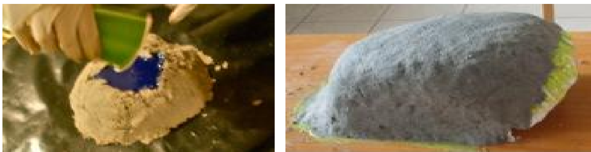
Εικόνα 6.10: Ανάμιξη του Putty με τον σκληρυντή του και επικάλυψη του καλύμμα-
