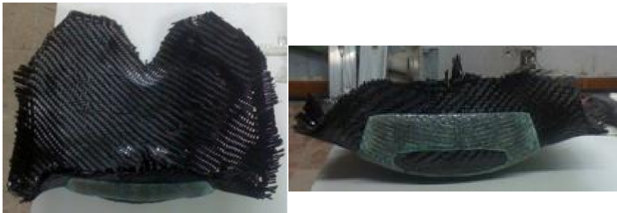
Εικόνα 6.4: Κατά τη διάρκεια του πολυμερισμού της ρητίνης
