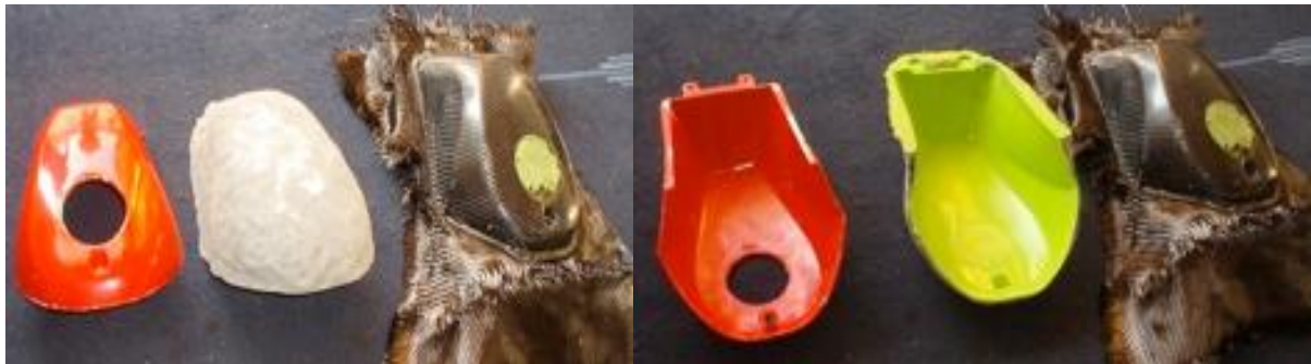
Εικόνα 6.14: Πρωτότυπο κομμάτι, καλούπι και το αντίστοιχο ανθρακονημάτινο
