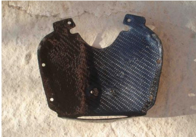
Εικόνα 6.5: Ανθρακονημάτινη μάσκα γυαλισμένη και περασμένη με βερνίκι
