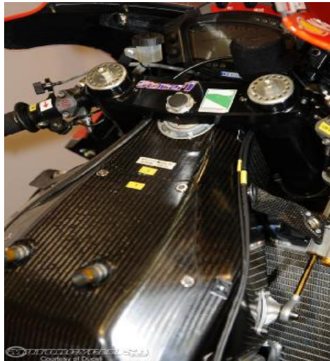
Εικόνα 5.2: Ανθρακονημάτινο πλαίσιο μοτοσυκλέτας
