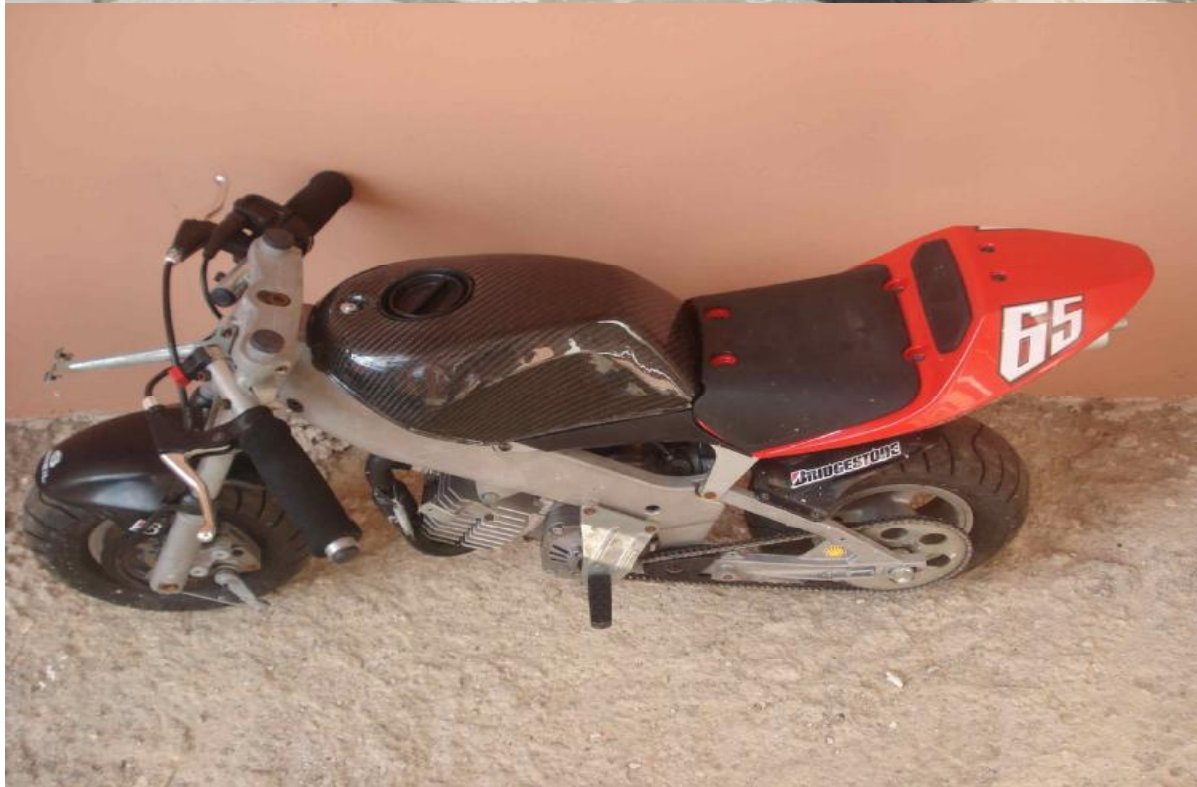
Εικόνες 7.2, 7.3: Η μοτοσυκλέτα με ανθρακονημάτινο πλέον, κάλυμμα ντεπόζιτου και μάσκα
