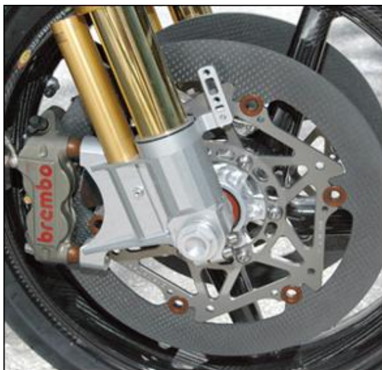
Εικόνα 5.1: Αγωνιστικοί ανθρακονημάτινοι δίσκοι «πλευστής» σύνδεσης με τον τροχό
