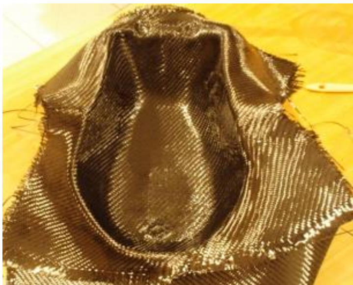
Εικόνα 6.13: Μετά την εφαρμογή τριών στρώσεων ανθρακονήματος
