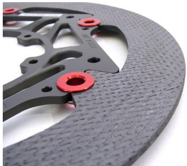
Εικόνα 5.1: Αγωνιστικοί ανθρακονημάτινοι δίσκοι «πλευστής» σύνδεσης με τον τροχό
