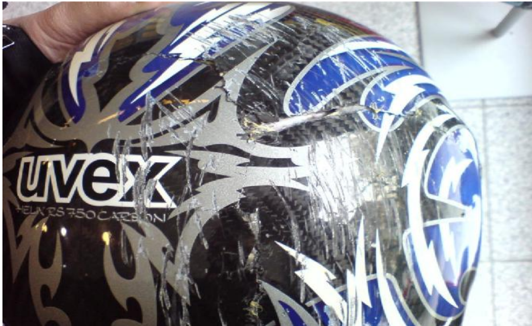
Εικόνα 5.6: Κράνος κατασκευασμένο από ανθρακόνημα ύστερα από πτώση
