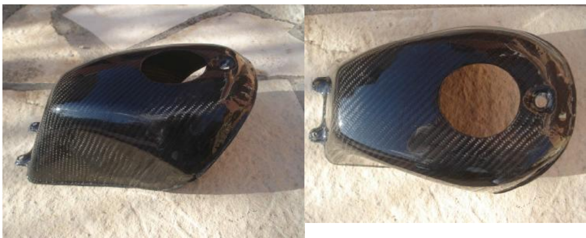
Εικόνα 6.15: Το ανθρακονημάτινο κάλυμμα του ντεπόζιτου, γυαλισμένο και περασμένο με βερνίκι
