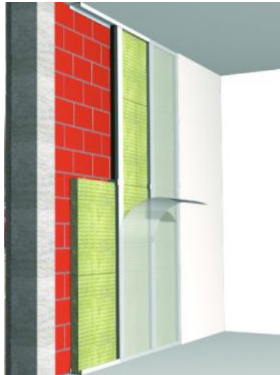
Σχήμα 6.1: Εσωτερική μόνωση τοίχου
