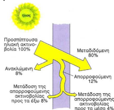
Σχήμα 6.8: Κατανομή της ηλιακής ακτινοβολίας που προσπίπτει σε ένα τζάμι.
