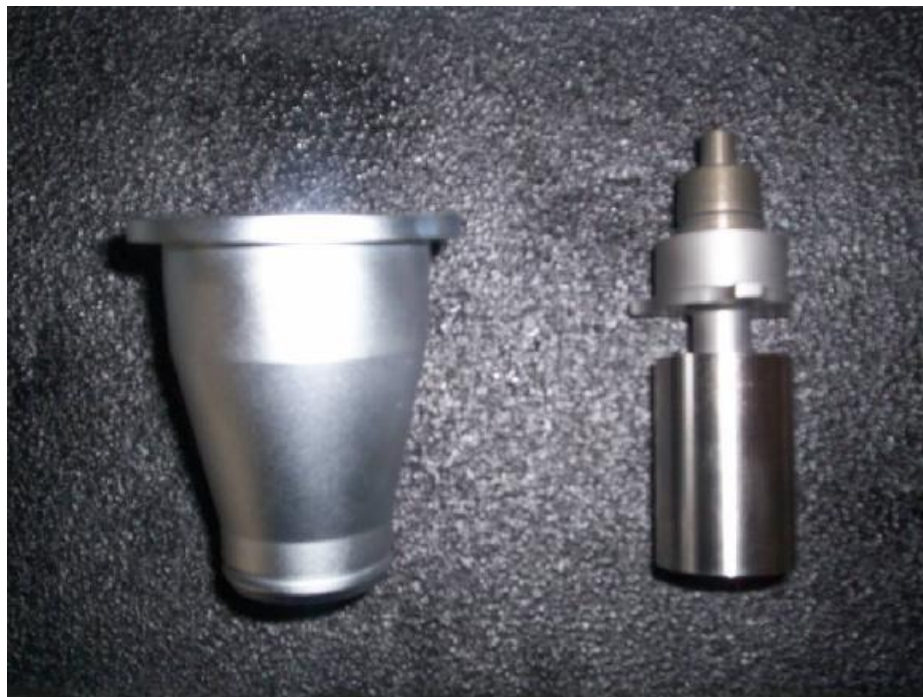
Σχήμα 6.2.2. Μέρη ρεομέτρου που χρησιμοποιούνται για μετρήσεις με τη μέθοδο Couette.
