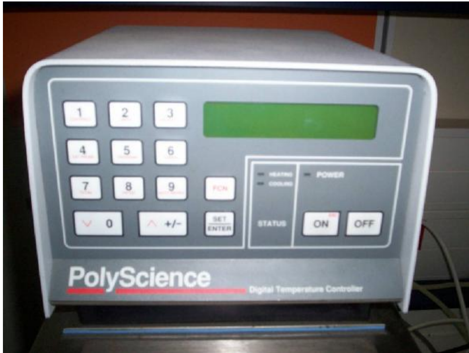
Σχήμα 6.2.3. Αναπόσπαστο κομμάτι της πειραματικής διάταξης του ρεομέτρου για τη ρύθμιση της
