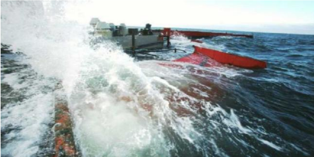
Εικόνα Β)ΙΙΙ.2.1)1 : Το πρωτότυπο μοντέλο Wave Dragon κλίμακας 1:4,5 στο Nissum Brending της Δανίας.
