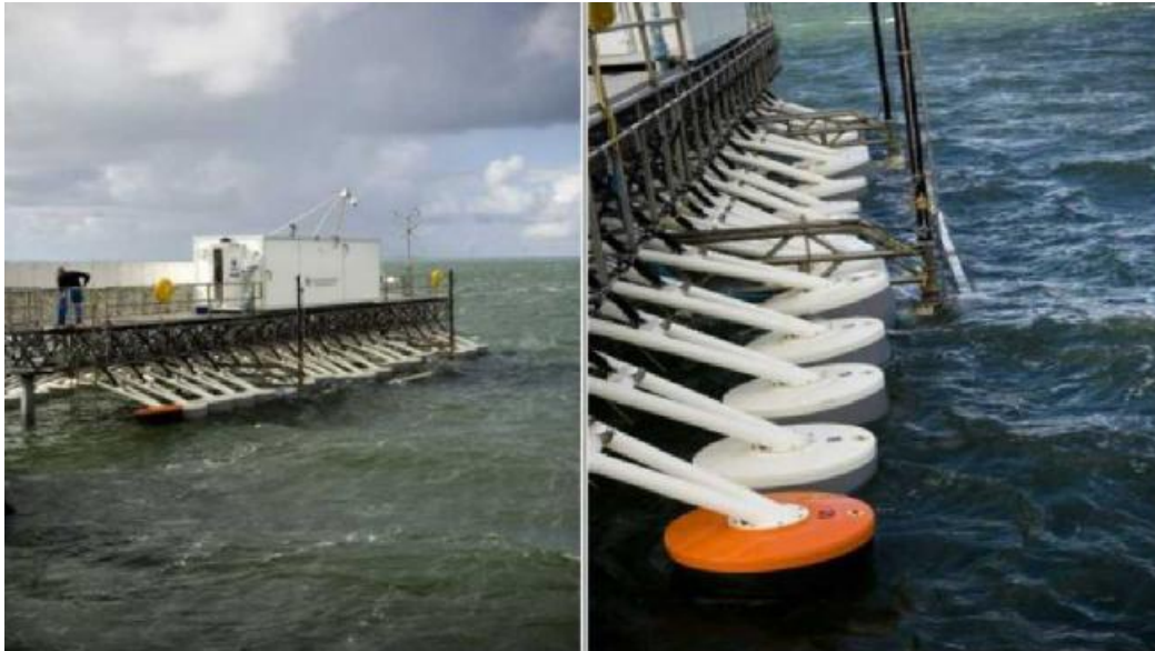
Εικόνα Β)ΙΙΙ.3.1)2 : Πλάγια όψη και μία από τις δύο σειρές σημαδούρων του μοντέλου Wave Star© στο Nissum Bredning.
