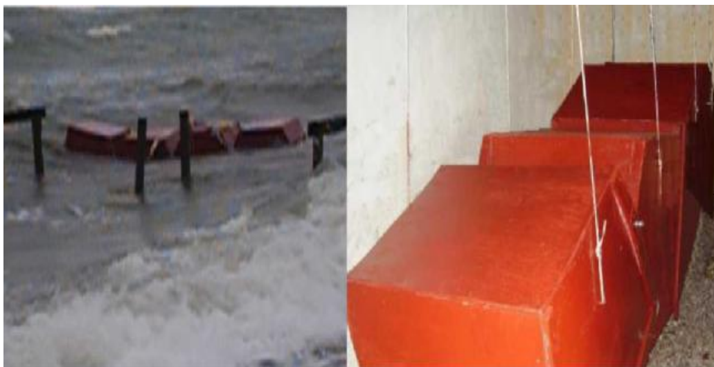
Εικόνα Β)ΙΙΙ.4.3)2 : Ένα πρότιμο δοκιμαστικό μοντέλο Crestwing πολύ μικρής κλίμακας.
