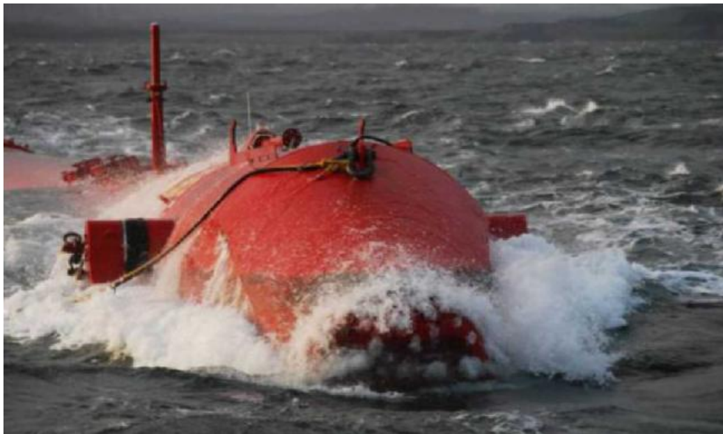
Εικόνα B)III.4.1)1 : Το πρωτότυπο μοντέλο Pelamis φυσικής κλίμακας σε λειτουργία.
