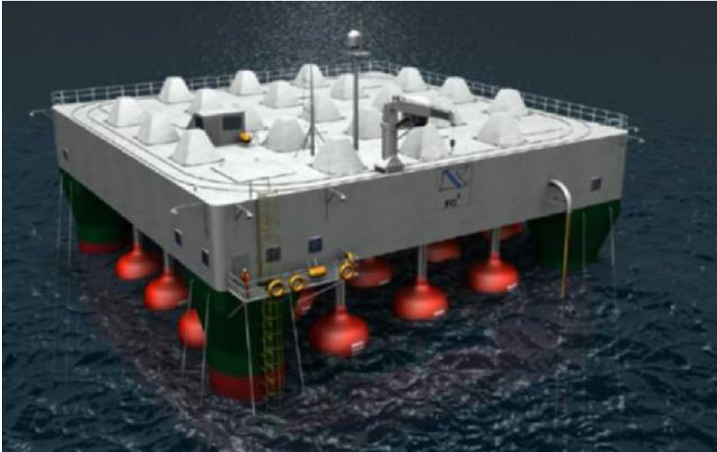
Εικόνα Β)ΙΙΙ.3.7)1 : Η πλωτή πλατφόρμα μετατροπής της κυματικής ενέργειας FO3.
