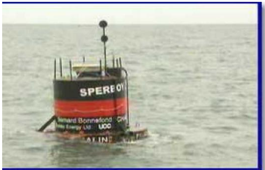
Εικόνα Β)III.1.3)1 : Ένα παλιότερο δοκιμαστικό μοντέλο Sperbooy™ σε λειτουργία στην ανοιχτή θάλασσα.
