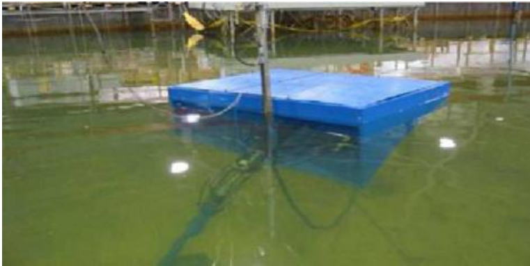
Εικόνα Β)II.3.1)2 : Δοκιμή ενός μοντέλου WET EnGen™ μικρής κλίμακας σε δεξαμενή τεχνητών κυμάτων.
