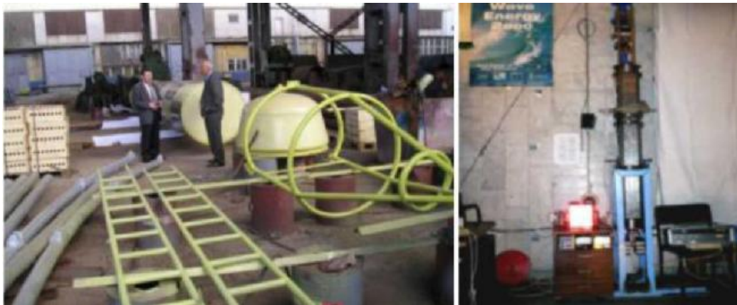
Εικόνα Β)III.3.10)3 : Ένα πρωτότυπο FWEPS πλήρους κλίμακας υπό κατασκευή και ο εσωτερικός μηχανισμός μετατροπής ενός μοντέλου FWEPS μικρής κλίμακας.
