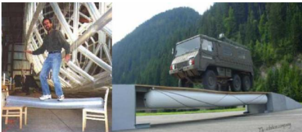
Εικόνα Β) III.3.12)4 : Επίδειξη της αντοχής των θαλάμων αέρα του μετατροπέα WaveBlanket.
