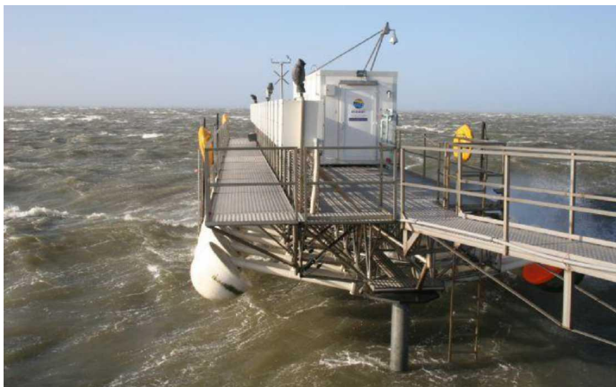
Εικόνα B)III.3.1)1 : Το μοντέλο Wave Star© κλίμακας 1:10 στο Nissum Bredning της (ΔΑΝΙΑΣ).ΔΙΑΚΡΙΝΟΝΤΑΙ ΟΙ ΣΗΜΑΔΟΥΡΕΣ ΣΕ ΑΝΥΨΩΜΕΝΗ ΘΕΣΗ ΕΚΤΟΣ ΛΕΙΤΟΥΡΓΙΑΣ.
