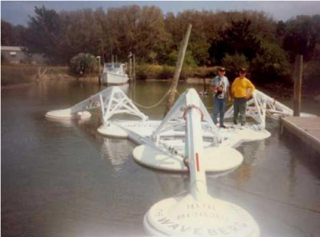
Εικόνα Β)II.4.1)1 : Το δοκιμαστικό μοντέλο Waveberg™ πριν από την ρυμούλκηση του στην επιλεγμένη τοποθεσία εγκατάστασης έξω από τις ακτές της Florida το 1996.
