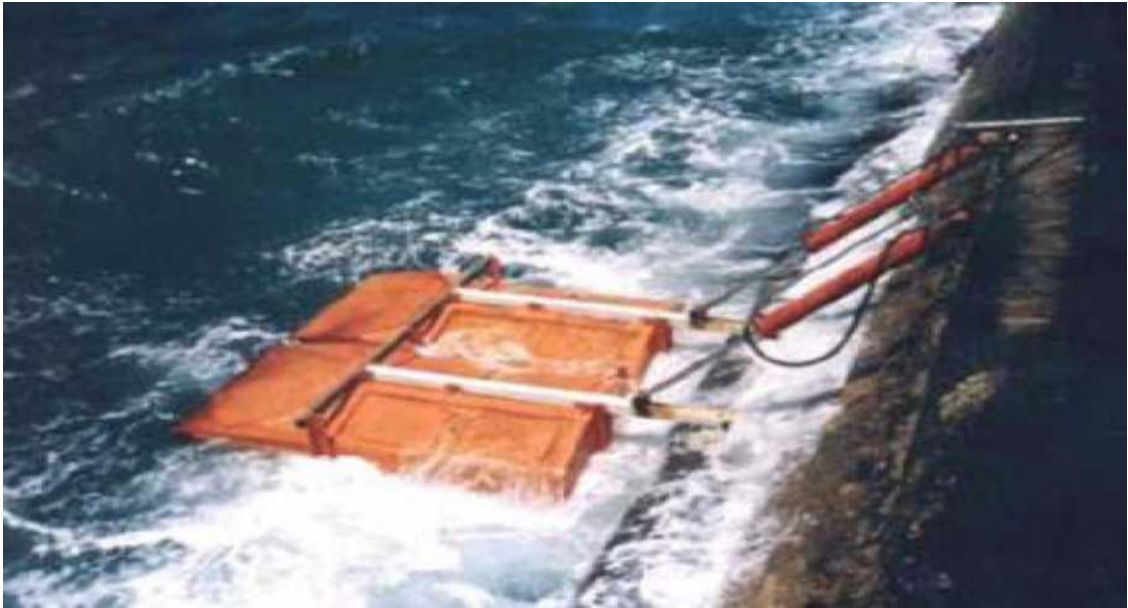
Εικόνα B)I.3.2)1 : Το εγκατεστημένο μοντέλο SDE πλήρους κλίμακας στο Ισραήλ.
