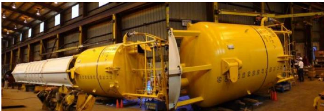
Εικόνα Β)III.3.2)3 : Το μοντέλο AquaBuOY 2.0 υπό κατασκευή
