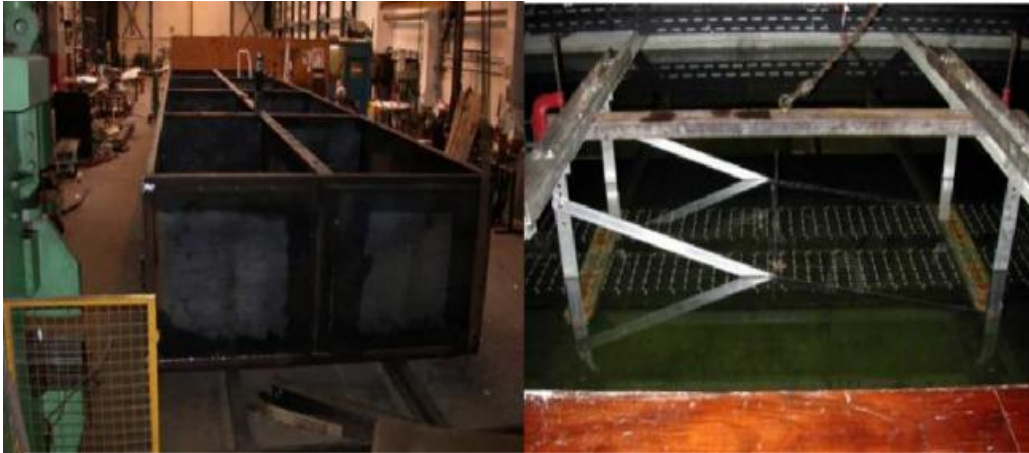
Εικόνα Β)III.1.4)3 : Το μοντέλο WaveMaster των 20 μέτρων υπό κατασκευή και ένα πειραματικό μοντέλο WaveMaster μικρής κλίμακας σε δοκιμή σε δεξαμενή δημιουργίας τεχνητών κυμάτων.
