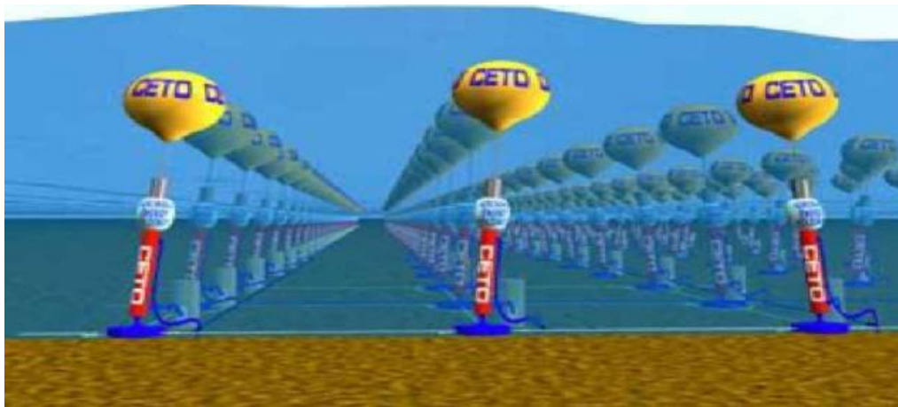
Εικόνα B)III.3.5)1 : Μια «φάρμα κυμάτων» με εκατοντάδες εγκατεστημένους μετατροπείς CETO™.
