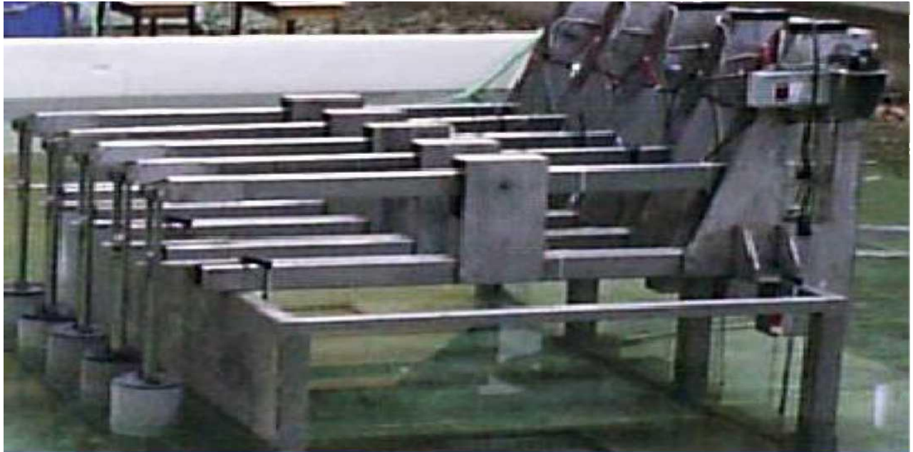
Εικόνα Β)Ι.3.1)3 : Το δοκιμαστικό μοντέλο κλίμακας 1:15 εμπρός του κυματοθραύστη σε δεξαμενή δημιουργίας τεχνητών κυμάτων στο Μετσόβιο Πολυτεχνείο.
