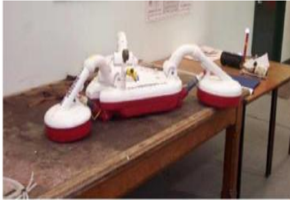
Εικόνα Β)II.4.1)4: Το πιο πρόσφατο πειραματικό μοντέλο Waveberg™ κλίμακας 1:50 του 2006.
