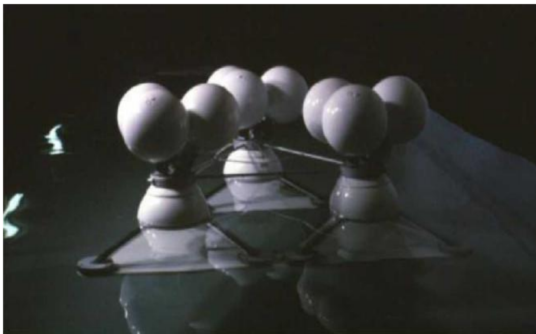
Εικόνα B)III.3.9)1 : Τρεις δοκιμαστικοί μετατροπείς OWEC® σε δεξαμενή τεχνητών
