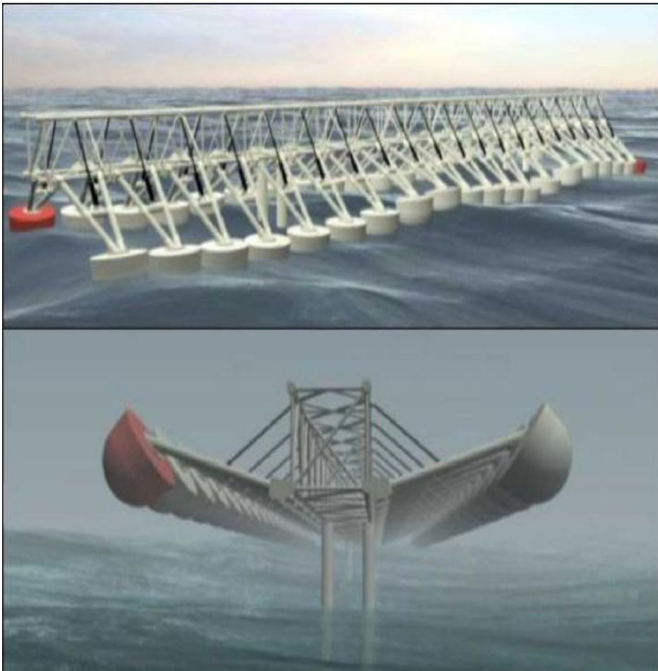
Εικόνα Β)III.3.1)3 : Η κεντρική γέφυρα του Wave Star© με τις δύο σειρές από πλωτά σε θέση λειτουργίας και ασφαλείας.
