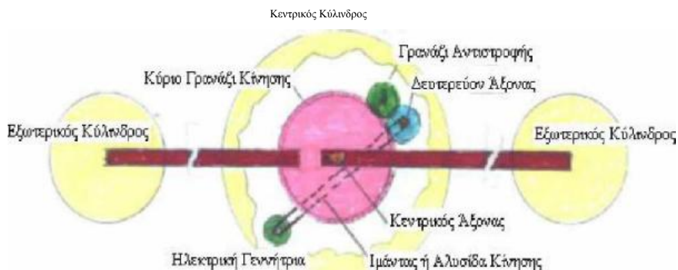
Εικόνα Β)III.4.5)2 : Πλάγια τομή του μετατροπέα Floating Wave Generator.
