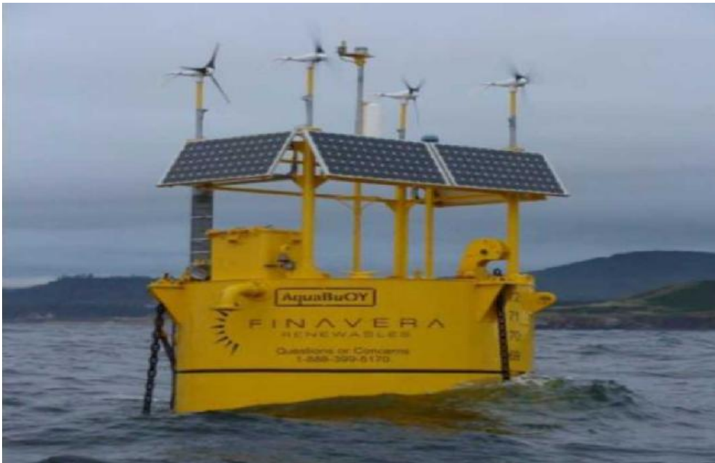
Εικόνα Β)ΙΙΙ.3.2)1 : Το μοντέλο AquabuOY 2.0 με ενσωματωμένες ανεμογεννήτριες και φωτοβολταϊκά πάνελς, στη θάλασσα έξω από το Newport του Oregon.
