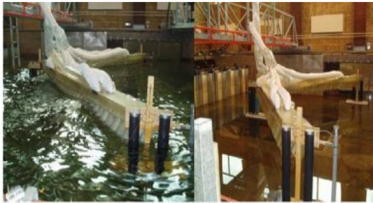
Εικόνα Β)Π.1.14 : Δοκιμή του πειραματικού μοντέλου MAWEC κλίμακας 1:40 σε δεξαμενή τεχνητών κυμάτων.
