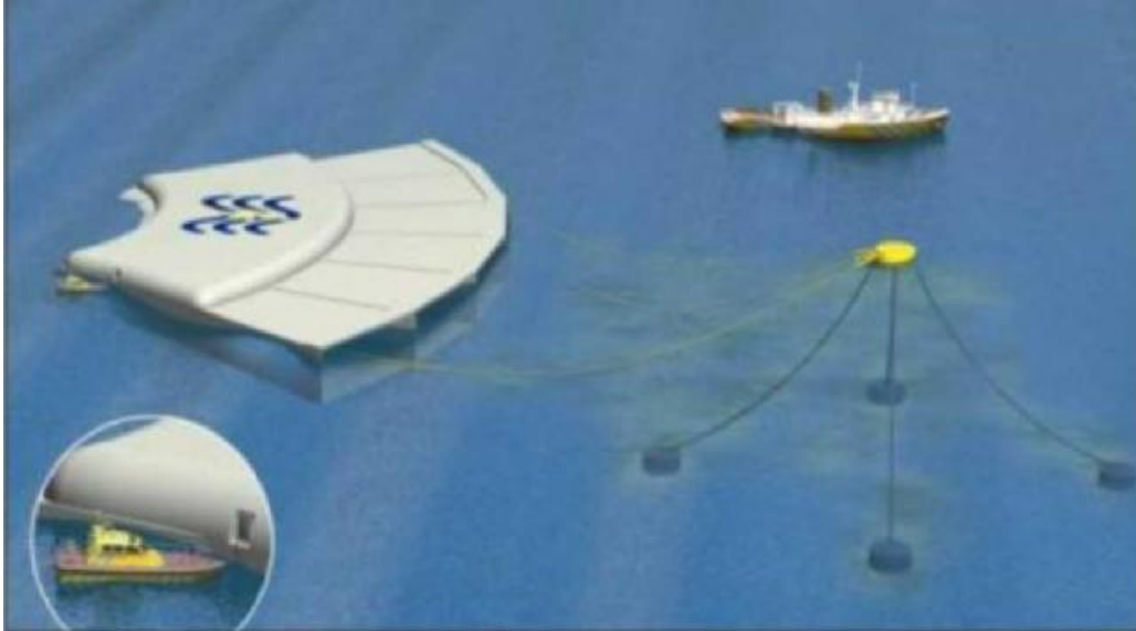
Εικόνα Β)III.5.2)1 : Η πλατφόρμα μετατροπής WEC με 6 ενσωματωμένους αεραγωγούς.
