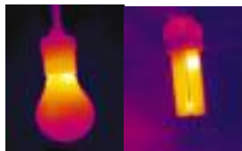
Εικόνα 8.1 : Θερμογράφημα λαμπτήρα πυρακτώσεως (αριστερά) και ηλεκτρονικού λαμπτήρα (δεξιά).
