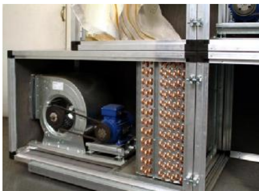
Σχήμα 1.3 : Θερμαντικό και ψυκτικό στοιχείο της ΚΚΜ
