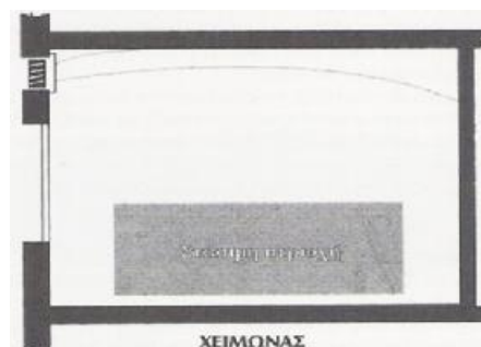
Σχήμα 1.36: Πορεία της ροής του θερμού αέρα που εκπέμπεται από ένα στόμιο
