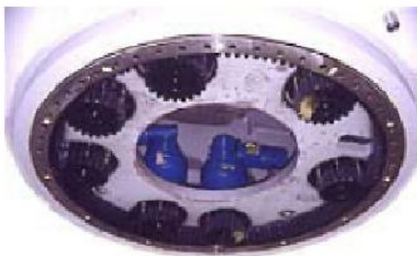
Εικόνα 6.11: σύστημα προσανατολισμού ανεμογεννήτριας
