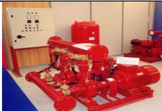
Εικόνα 5.6: μόνιμο υδροδοτικό πυροσβεστικό δίκτυο
