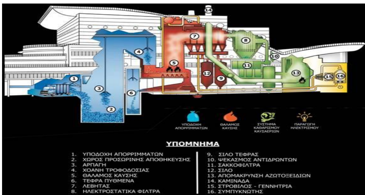
Εικόνα 4.4 : Τυπική διάταξη μονάδας καύσης (www.wtert.gr)
